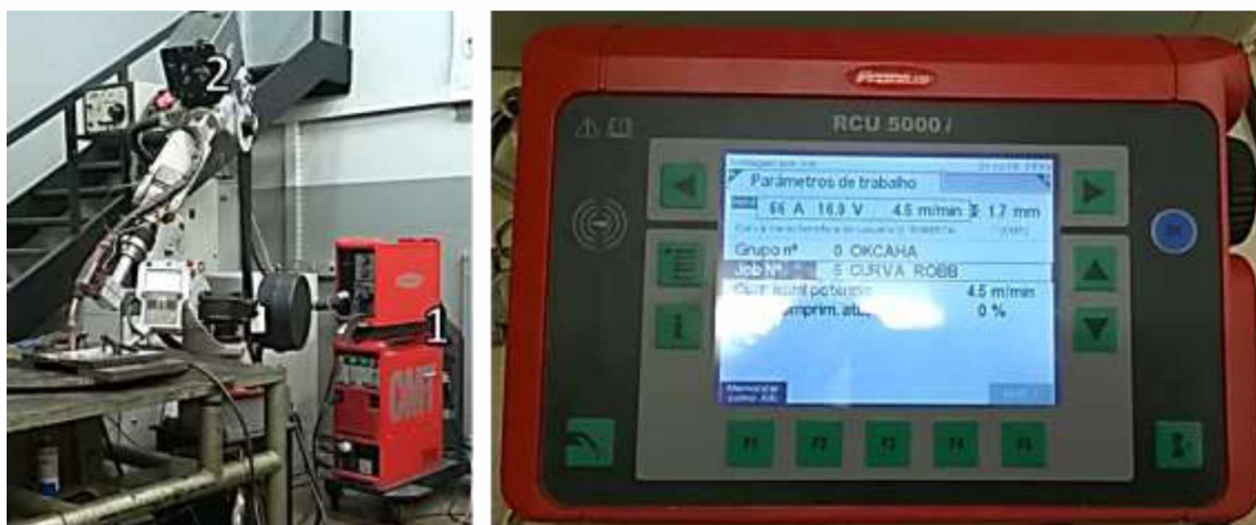
Figura 32 – À esquerda a fonte FRONIUS TPS5000CMT (1) e o robô MOTOMAN HP20 (2). À direita o painel de controle ( RCU5000 ) e monitoramento dos parâmetros de soldagem da fonte. (Moreira, 2016)
