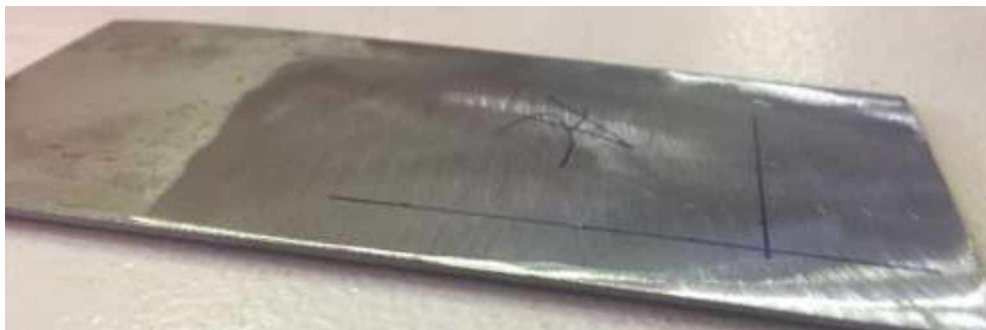
Figura 31 – Chapa de aço após tratamento. Detalhe para a região tratada à direita (onde houve deposição de pinos) e a não tratada à esquerda.
