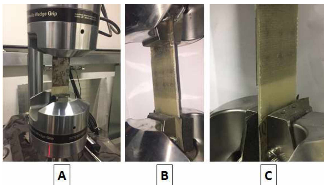
Figura 61 – (A) Máquina de tração com o corpo de prova já posicionado; (B) Detalhe da garra fixando a chapa de aço e o compósito; (C) Detalhe do uso da lixa entre compósito e garra.
