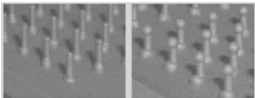
Figura 22 – Pinos soldados por MIG/MAG CMT PIN. (a) Pinos cilíndricos; (b) Pinos de cabeça abaulada. Fonte: Ucsnik, Scheerer, Zaremba, & Pahr, 2009.
