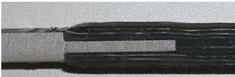
Figura 7 – Resina aplicada, compactada e curada sobre superfície metálica. Fonte: Gradinger, Ucsnik, & Scheerer, 2011
