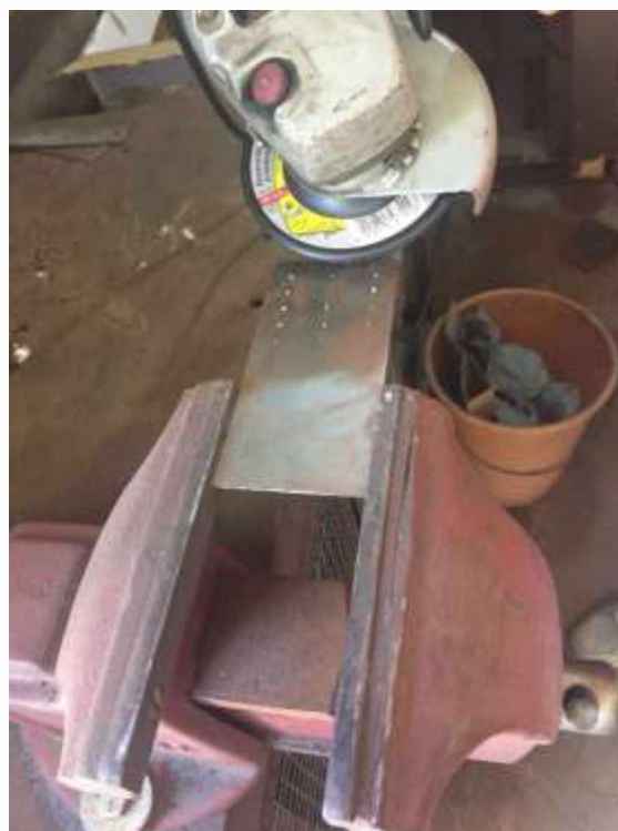
Figura 29 – Chapa de aço cortada pela metade e pronta para o início do processo de tratamento superficial.
