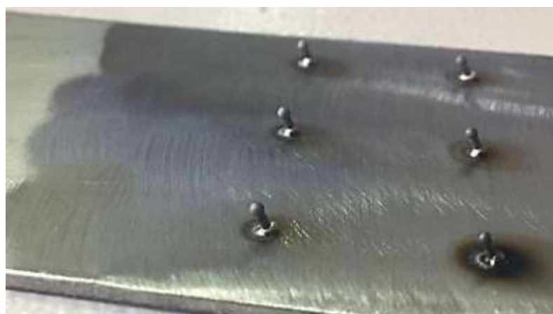
Figura 59 – Seis pinos inclinados (25 graus) soldados na superfície da chapa metálica.
