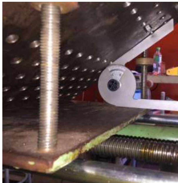
Figura 36 – Transferidor sendo utilizado para medição da inclinação da mesa de suporte.
