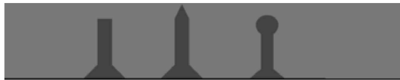
Figura 11 – Algumas formas de pinos para união híbrida. Em sequência: cilíndrico (esquerda), cabeça piramidal (meio) e cabeça redonda (direita).
