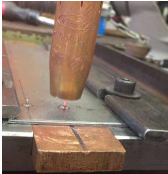
Figura 56 – Início do processo de deposição dos pinos inclinados. Detalhe para o contato entre chapa, arame de soldagem (pino) e tocha de soldagem.
