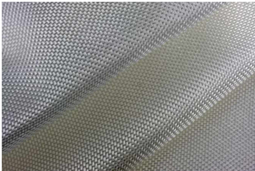
Figura 26 – Modelo de tecido do tipo Plain Weave de Fibra de Vidro. Fonte: Sercel.
