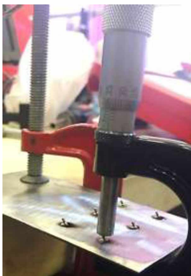
Figura 52 – Etapa de medição da altura dos pinos.
