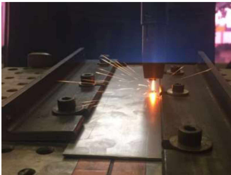
Figura 58 – Momento de soldagem do pino na chapa metálica.
