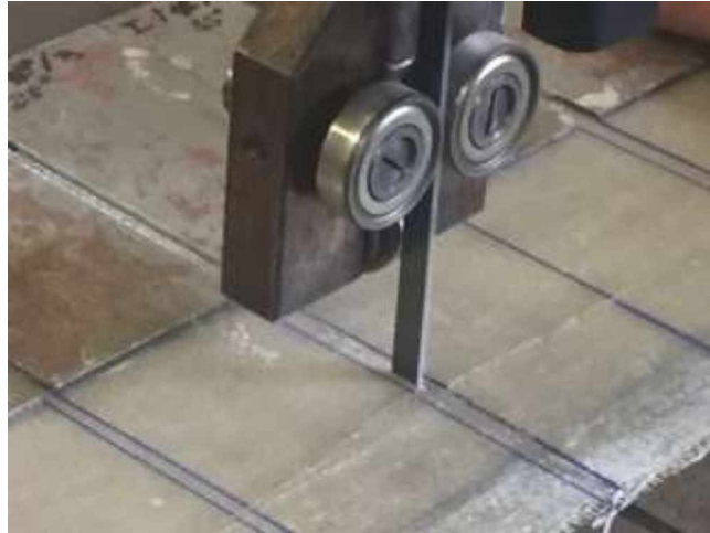
Figura 43 – Corte do material compósito, separando os CPs.
