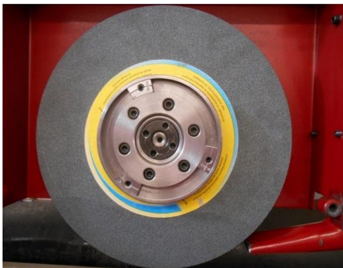
Figura 10 - Rebolo do tipo reto de carbeto de silício 36C46KVK
