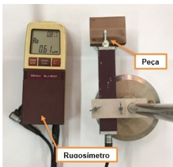
Figura 15 - Medição da rugosidade do ferro fundido cinzento
