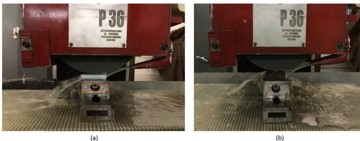
Figura 12 – Set-up de Retificação : (a) poliacetal, (b) ferro fundido cinzento
