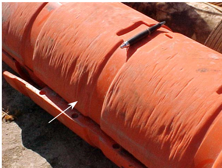
Figura 2.20 – Calha do PU após 44 meses de uso na plataforma P-19; segmento mais significativamente desgastado na espessura (região indicada pela seta), FRANCO, (2002).
