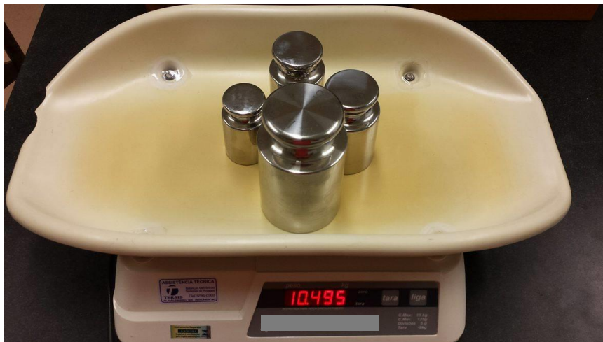
Figura 3.4 – Calibração da Balança Neonatal D modelo W.
