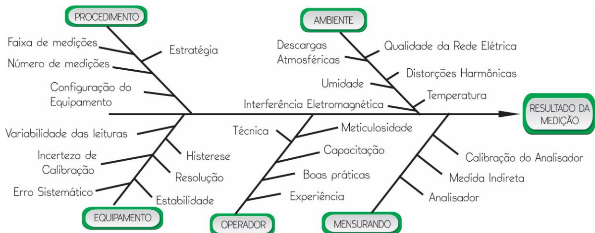
Figura 3.11 - Diagrama de causa e efeito para o processo de medição da potência de corte e coagulação fornecida pelo bisturi elétrico.
