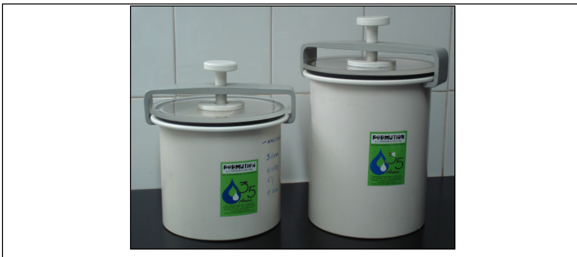
Figura 06. Jarras de anaerobiose de 2,5L (Permution, E.J.Hrieger & CIA LTDA)
