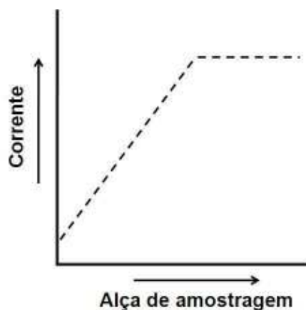
Figura 5: Esquema da dependência da altura do sinal amperométrico na MPA em função da variação da alça de amostragem. Mantendo outras variáveis constantes.
