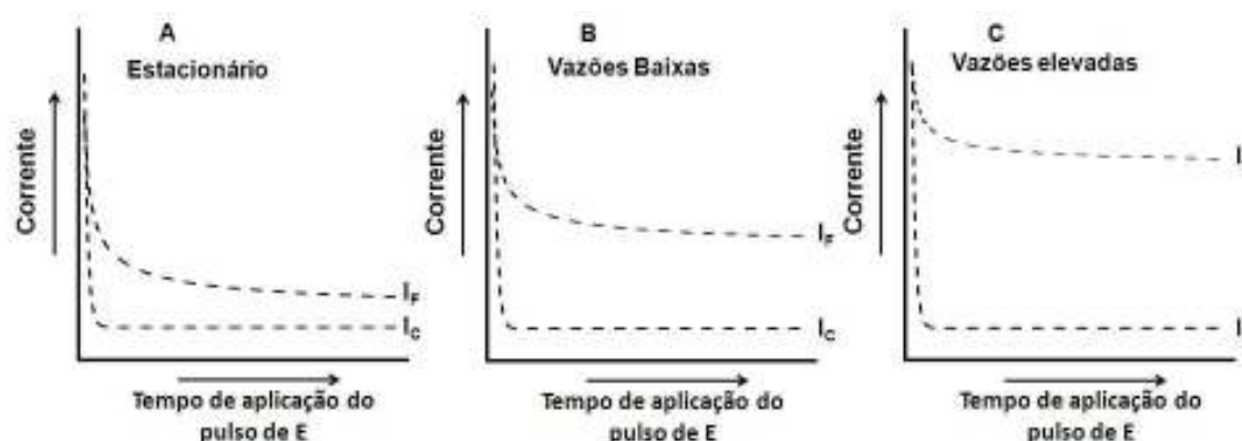
Figura 7: Dependência da corrente faradaica ( I_F ) e da corrente capacitiva ( I_C ) em função do tempo de aplicação de um pulso de potencial em uma solução estacionária (A) e em sistemas em fluxo com vazões baixas (B) e elevadas (C).
