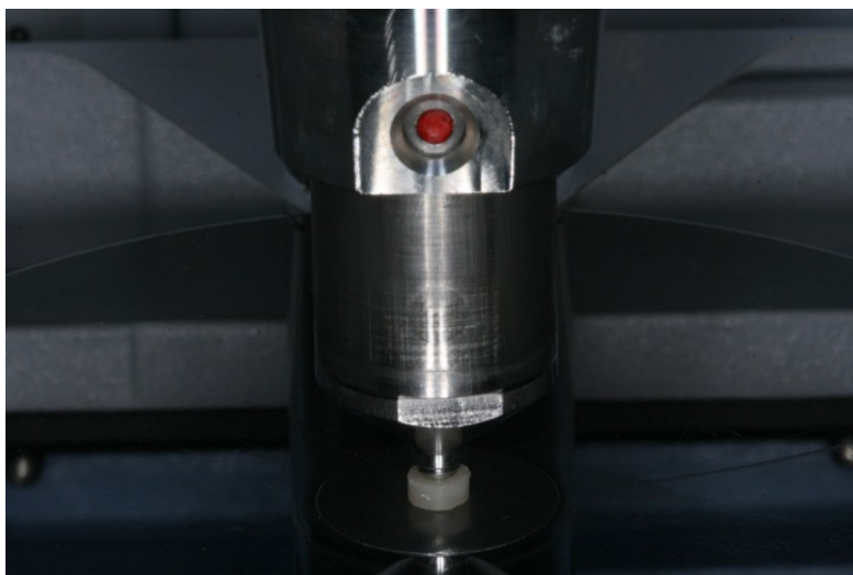
Figura 9: Avaliação do grau de conversão estático de resinas compostas através do Espectrofotômetro de InfraVermelho por Transformada de Fourier – FTIR.
