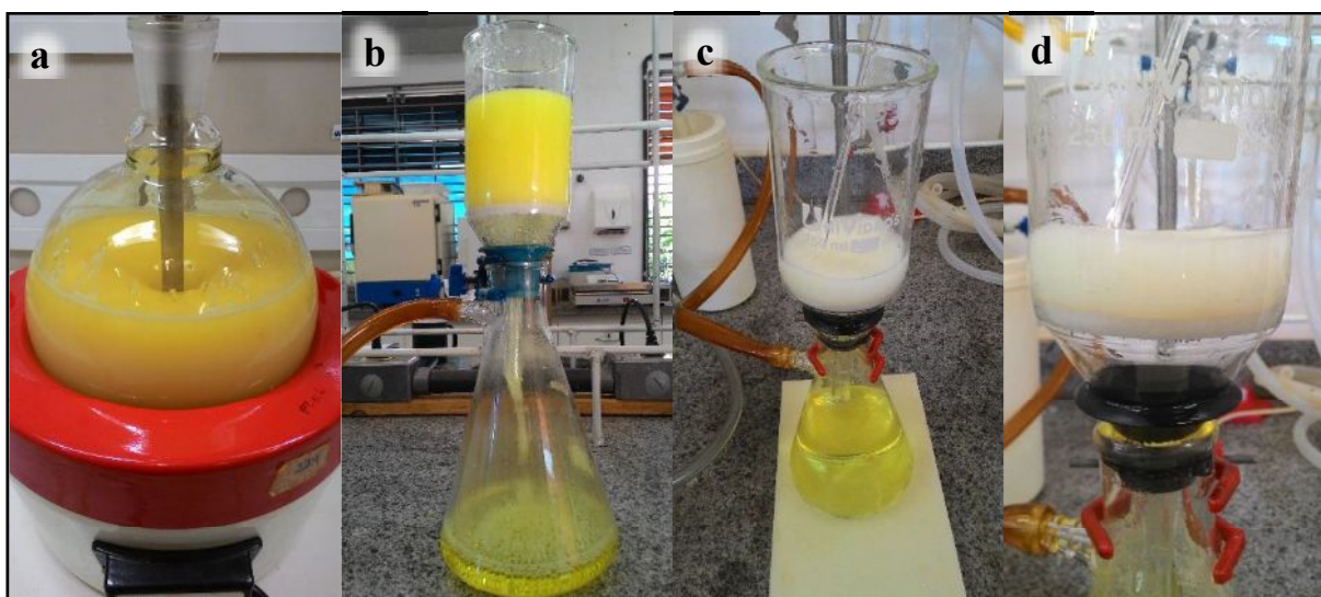
Figura 43 – Material deslignificado durante a etapa de branqueamento, (a) em solução, sob agitação e aquecimento; (b) mistura em filtração; (c) após filtração e enxágue e (d) holocelulose branqueada.
