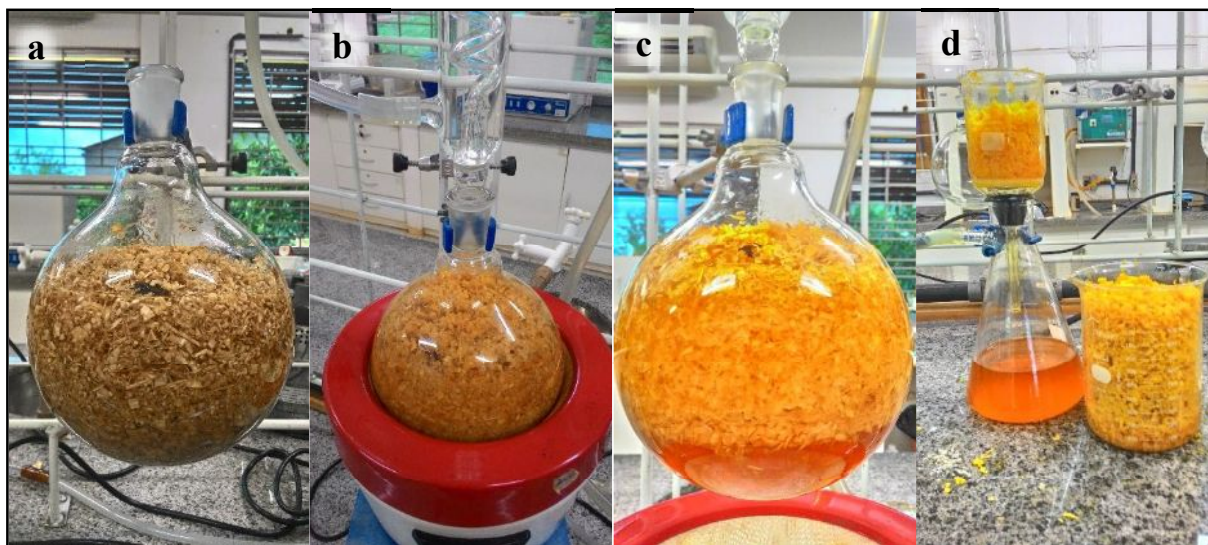
Figura 41 – Vagens da M. oleifera durante a etapa de deslignificação por rota ácida: (a) vagens trituradas imersas em solução etanólica de \text{HNO}_3 em balão de fundo redondo, (b) sistema em refluxo, (c) após refluxo e (d) em filtração.
