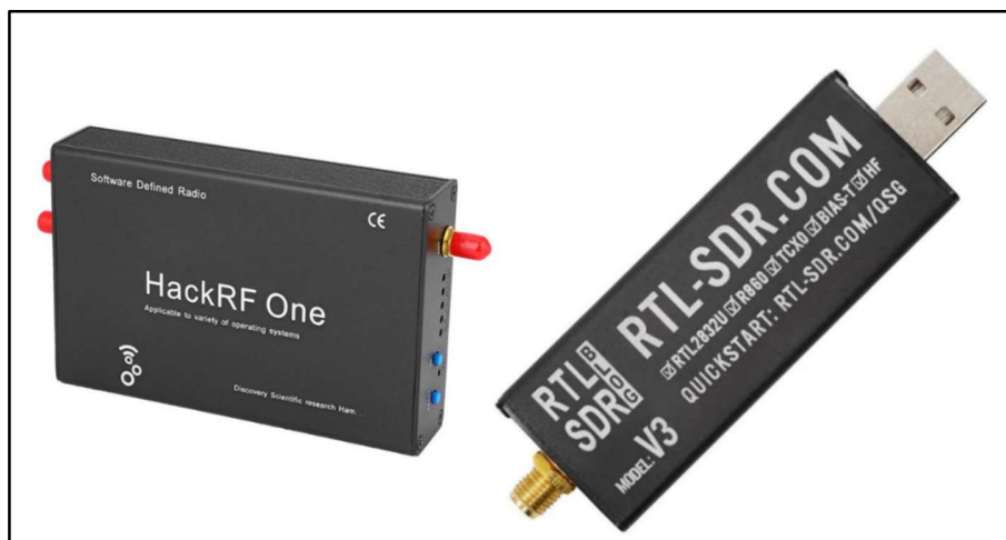
Figura 18 - SDRs utilizados no projeto: HackRF One e RTL-SDR.
