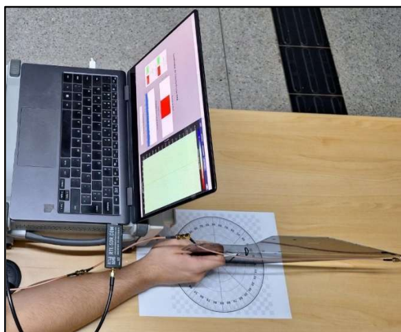
Figura 37 - Esquemático para obtenção do ângulo de azimuth da Antena HT8 através de um transferidor 360^\circ impresso.
