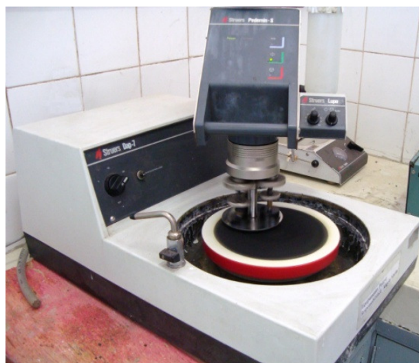
Figura 3.9 – Polidora Metalográfica Struers Ref. Dap-7.
