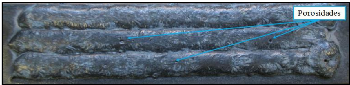
Figura 5.3 – Detalhe da Superfície das chapas revestidas com FeCrC+Ti com adição de arame não energizado de FeCrC+Nb.
