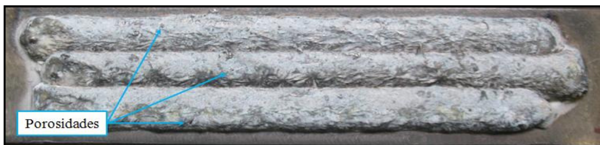
Figura 5.1 – Detalhe da Superfície das chapas revestidas com FeCrC+Ti
