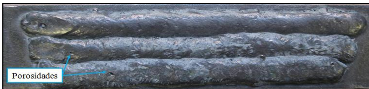
Figura 5.2 – Detalhe da Superfície das chapas revestidas com FeCrC+Ti com adição de arame não energizado de FeCrC.
