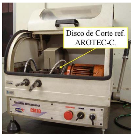
Figura 3.8 – Cortadora Metalográfica TECLAGO Ref. CM 70.
