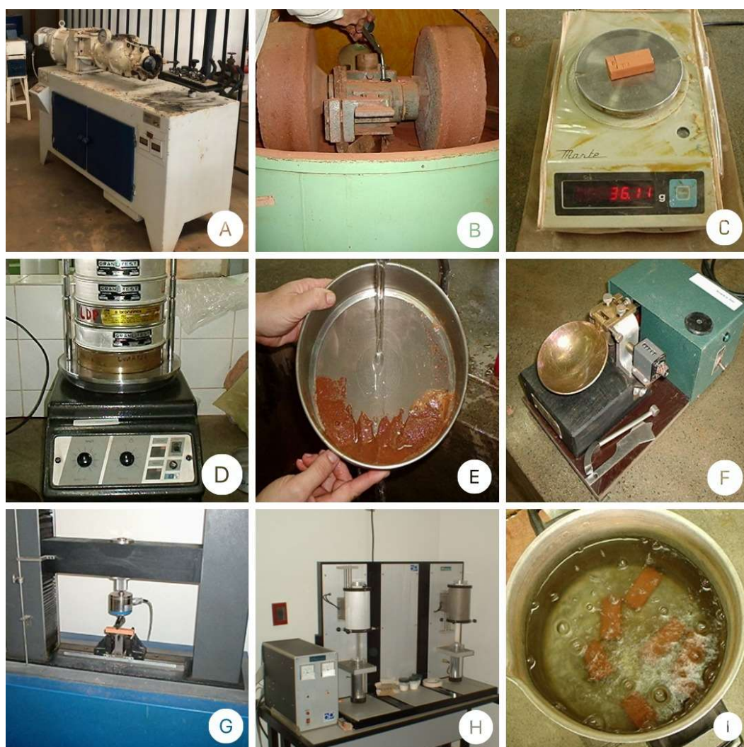
Figura 8 - Equipamentos Utilizados para caracterização da argila, (A) maromba para extrusão dos corpos de prova, (B) Moinho de pista perfurada, (C) balança de precisão, (D) Vibrador de peneiras, (E) peneira #325, (F) equipamento Casagrande usado no ensaio de limite de plasticidade, (G) prensa para ensaio de resistência mecânica, (H) equipamento de análise térmica diferencial e dilatômetro e (I) recipiente para ensaio de absorção de água.
