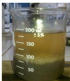
Figura 17 - Foto ilustrativa do efluente após a adição de alcalinizante e de tanino com a presença de flocos com duas colorações distintas.
