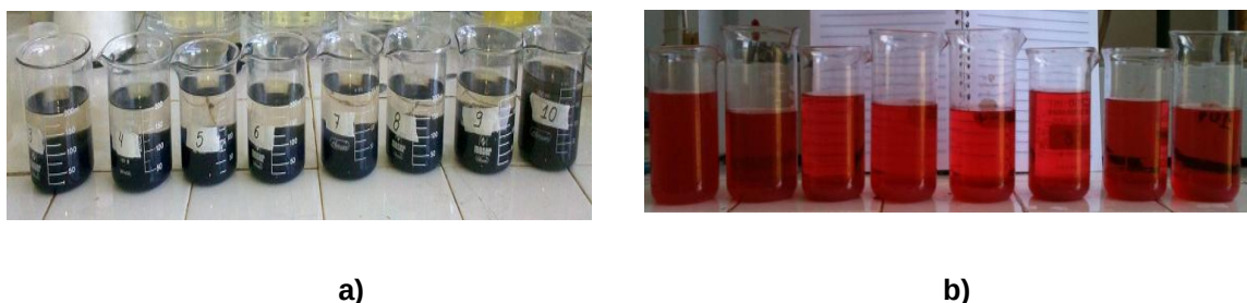
Figura 21 - Fotos ilustrativas do efluente de lavanderia industrial em todas as faixas de pH após a adição de 7500 ppm de: a) tanino e b) sulfato de alumínio.
