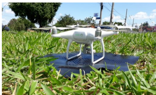
Figura 27 - Vant Phantom 4 PRO
