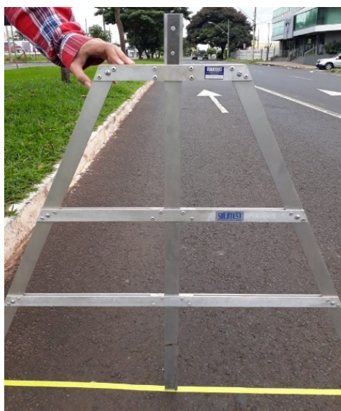
Figura 40 - Medidas das trilhas de roda interna e externa
