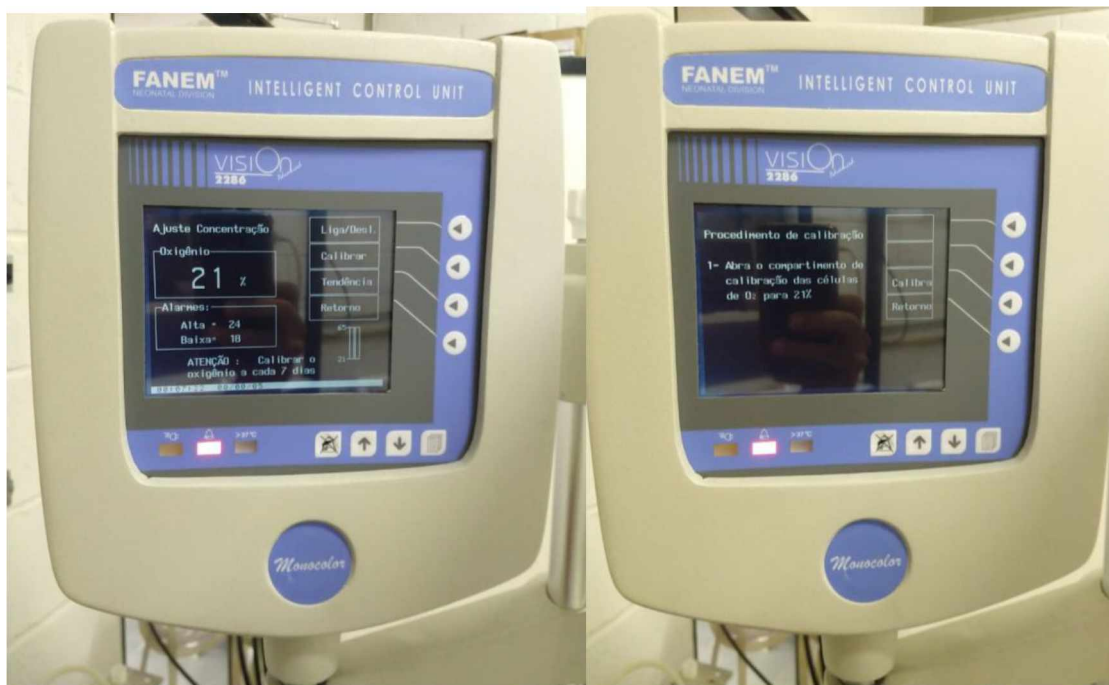
Figura 29 – Procedimento de calibração da célula de oxigênio.
