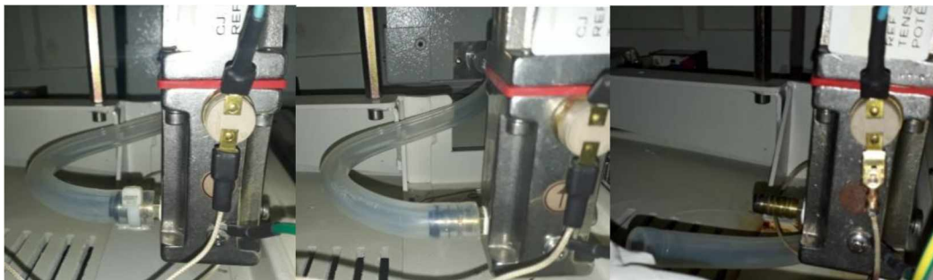
Figura 16 – Mangueira de silicone sendo removida.
