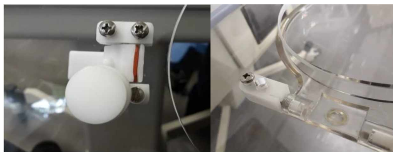
Figura 8 - Dobradiças parafusadas na cúpula.
