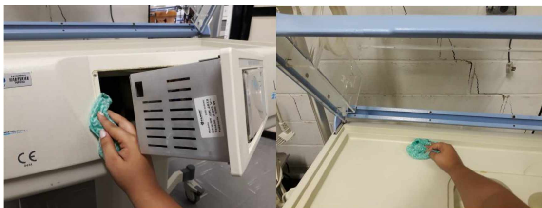
Figura 4 - Limpeza da base da incubadora 2.
