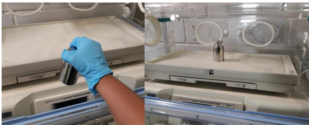
Figura 22 – Verificação do Sistema de Pesagem.
