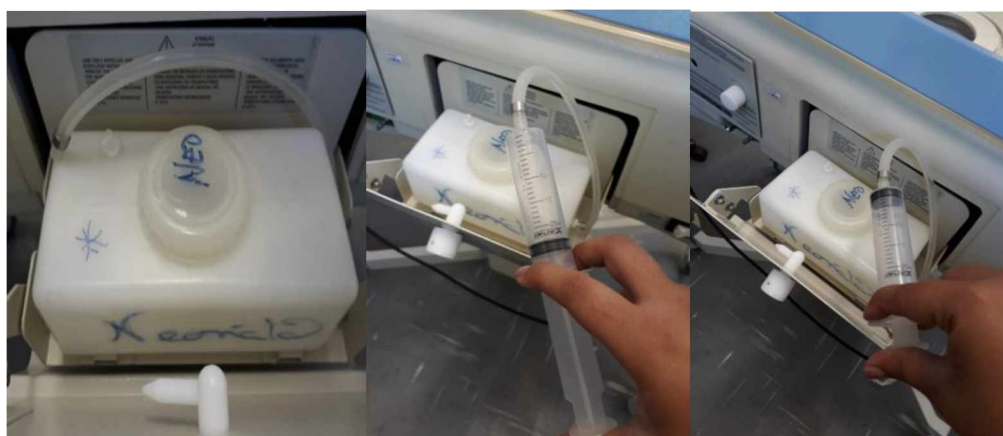
Figura 25 – Ar sendo retirado da mangueira de drenagem.
