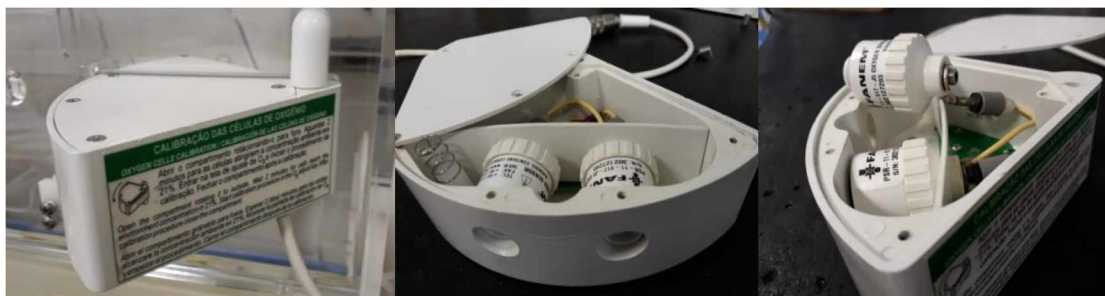
Figura 20 – Troca das células de oxigênio.
