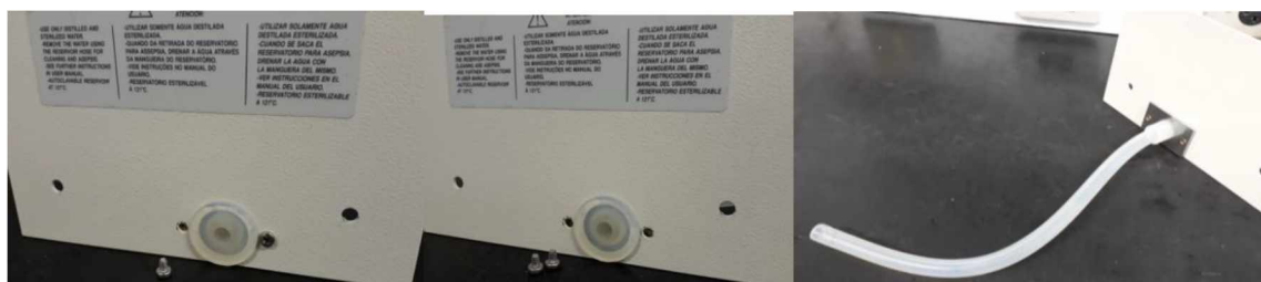
Figura 18 – Mangueira de silicone substituída.
