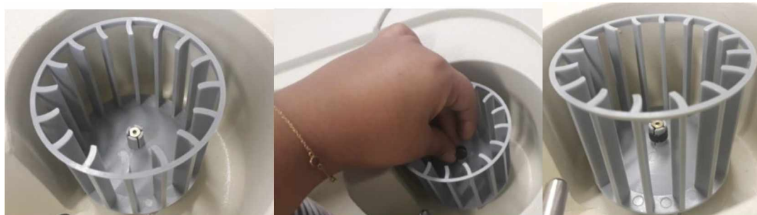
Figura 13 - Presilha sendo colocada na ventoinha.
