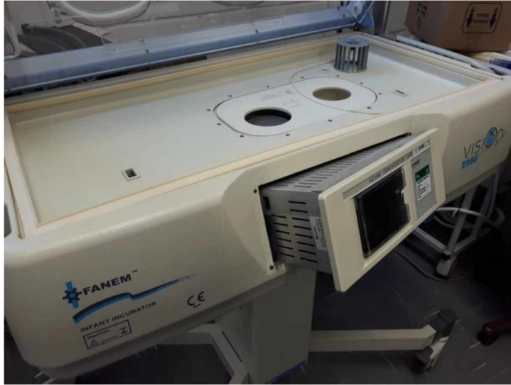
Figura 14 – Unidade controladora aberta.
