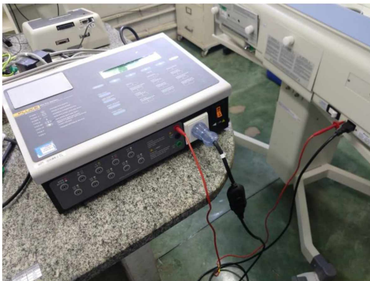
Figura 32 – Analisador de segurança elétrica conectado na incubadora.
