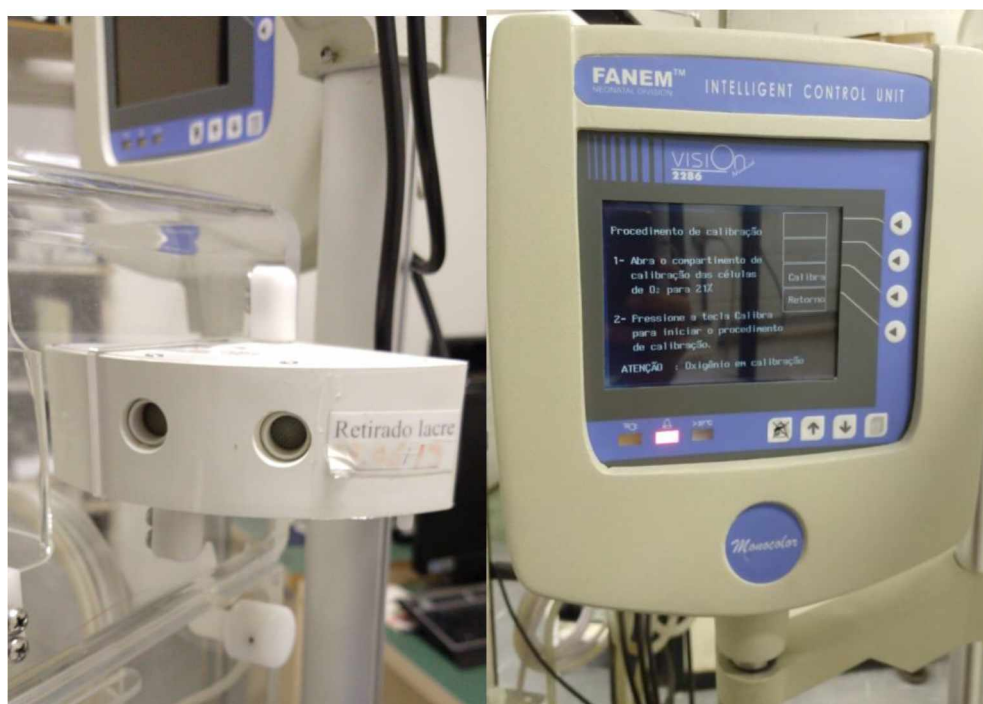
Figura 30 – Procedimento de calibração da célula de oxigênio.
