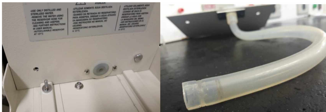
Figura 17 – Mangueira de silicone removida.
