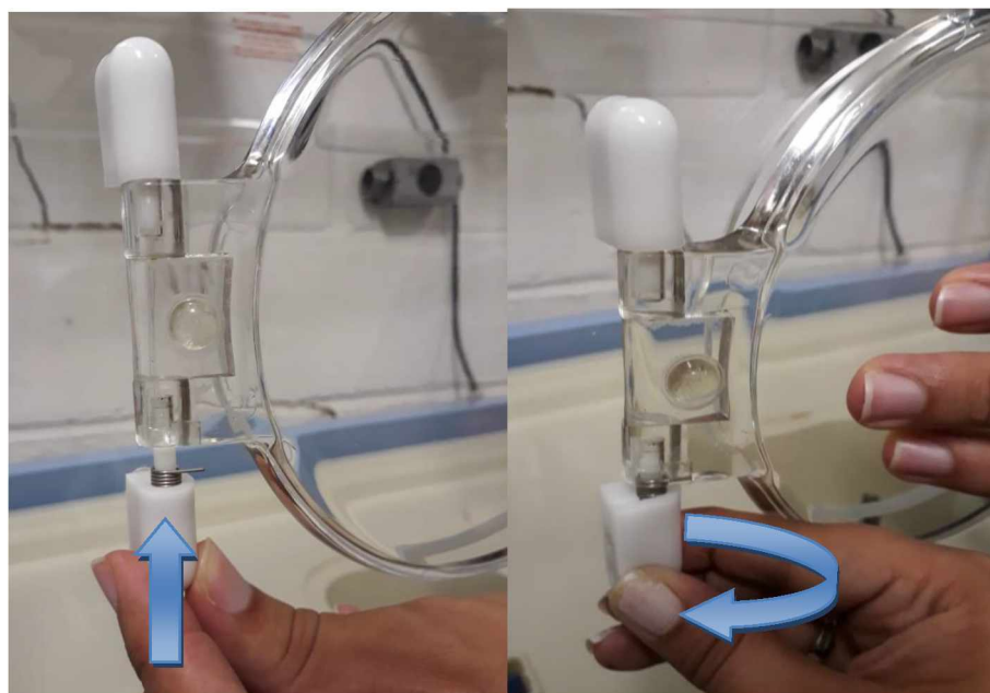
Figura 9 - Parafusando a dobradiça com mola.
