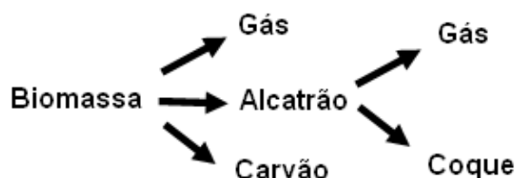
Figura 2.1 - Esquema da transformação de biomassa em gás de síntese (MESHCHERYAKOV e KIRILLOV, 2002).
