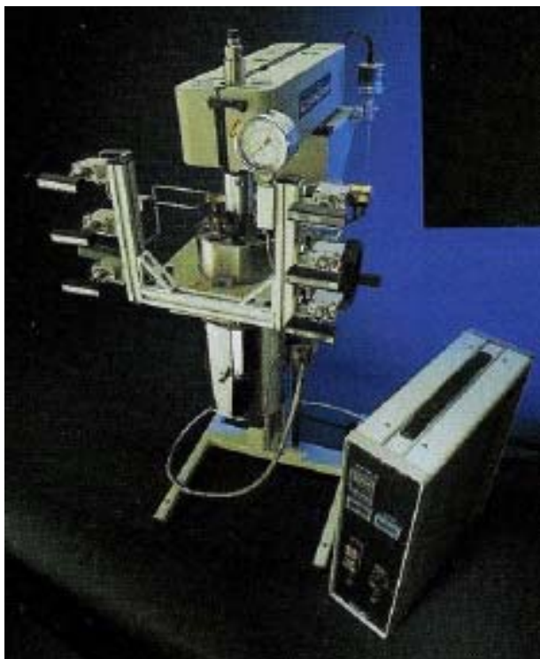
Figura 3.2 – Reator leito de lama com a camisa de aquecimento e torre de controle.
