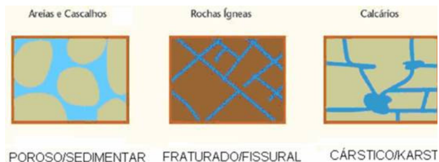
Figura 3-5: Tipos de aquíferos quanto à porosidade
