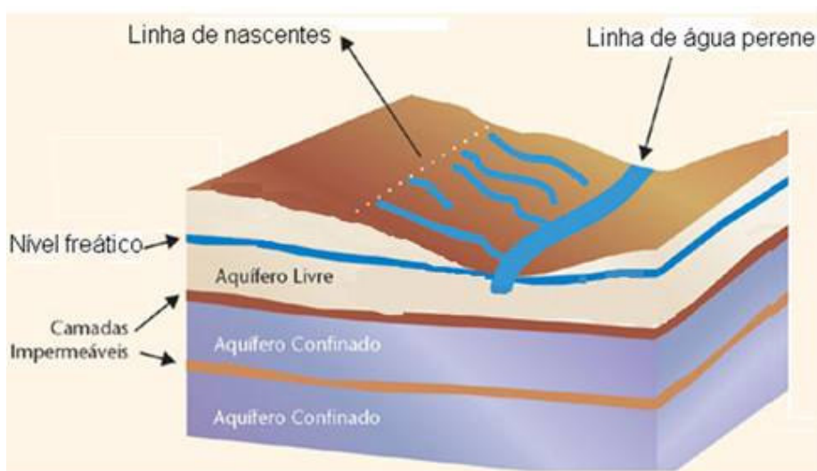
Figura 3-4: Tipos de aquíferos quanto à pressão da água
