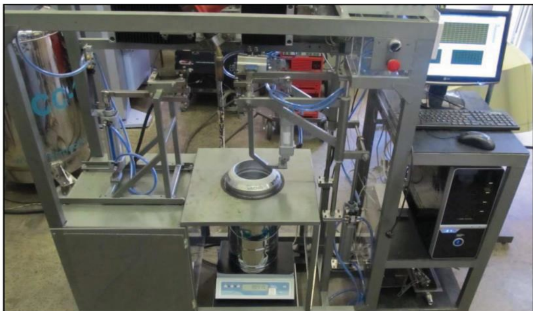
Figura 2.14 – Calorímetro de nitrogênio líquido proposto por Arévalo (2011)
