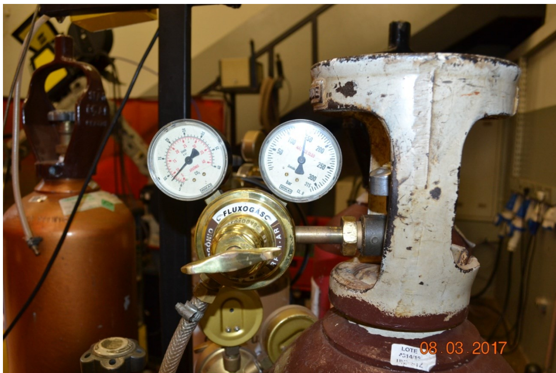
Figura 3.9 - Medidores de pressão e vazão utilizados
