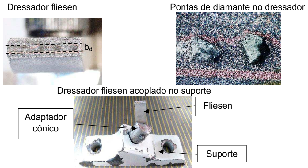
Figura 3. 6 – Imagens do dressador fliesen utilizado na dressagem do rebolo abrasivo de carbeto de silício.
