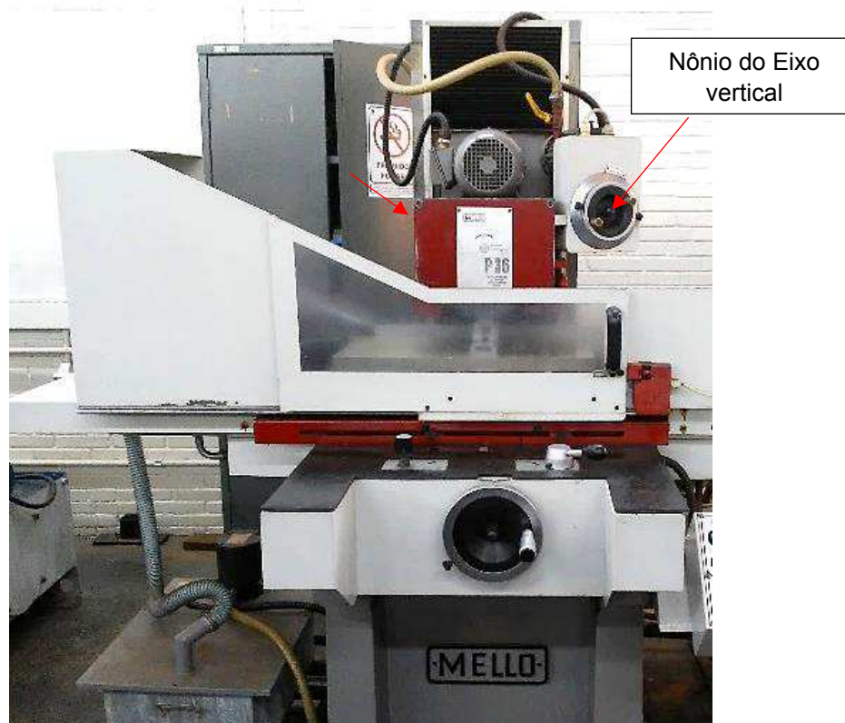
Figura 3. 1 – Máquina retificadora plana tangencial semiautomática, P36, empregada nos ensaios experimentais (disponível em Laboratório de Usinagem Convencional – UFU).
