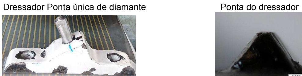
Figura 3. 7 – Imagens dos dressador ponta única de diamante utilizado na dressagem do rebolo abrasivo de carbeto e silício.
