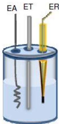
Figura 1: Representação de uma célula eletroquímica com três eletrodos (ET: eletrodo de trabalho; EA: eletrodo auxiliar e ER: eletrodo de referência).
