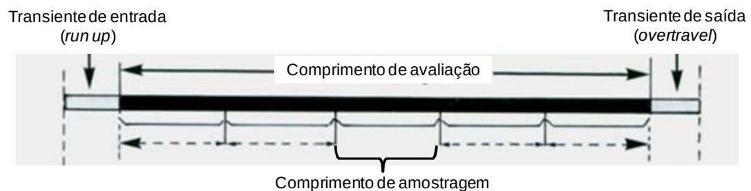
Figura 2.14 – Comprimentos de análises para cálculo da rugosidade (adaptada de SANTOS e SALES, 2007).
