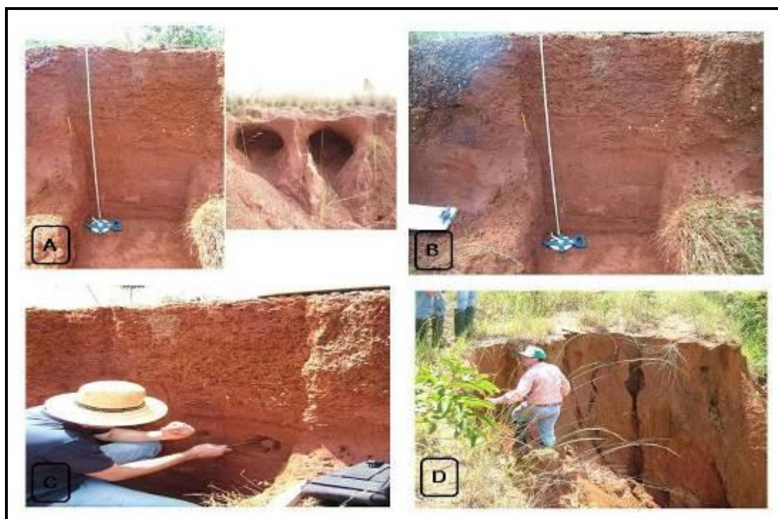
Figura 6 - (A) – Perfil 1 do solo em um dos canais erosivo e tipo de erosão em alcovas de regressão; (B); (C) – Demonstração dos respectivos horizontes, camada superficial de cascalho; (D) - Perfil amostrado com horizonte (Bw) na voçoroca principal da área de estudo.
