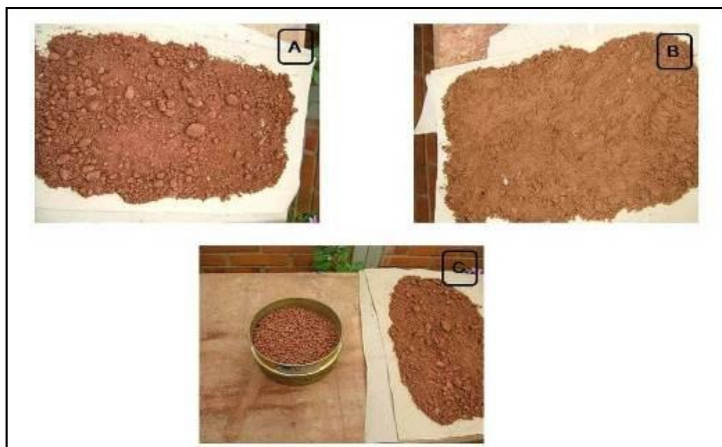
Figura 7 - Aspectos das amostras coletadas em campo: (A); (C) – material da camada superficial cascalhenta (0-50cm) do CE; (B) – material do horizonte Bw (0-45cm) da VP;– Material grosseiro da camada superficial.
