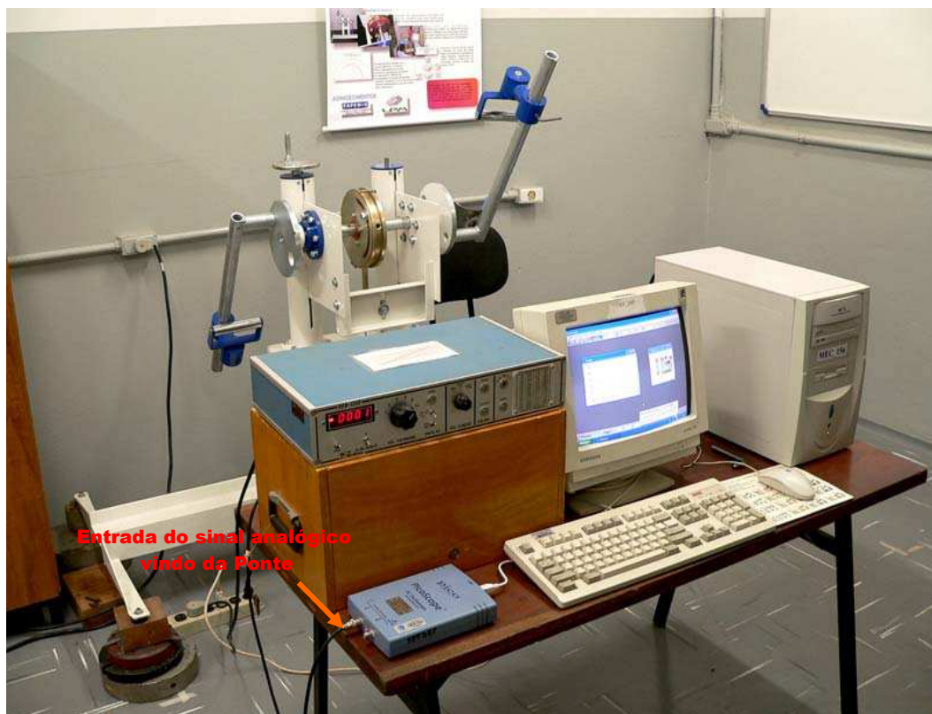
Figura 5.15 – Dispositivo projetado e instrumentação utilizada nos testes.
