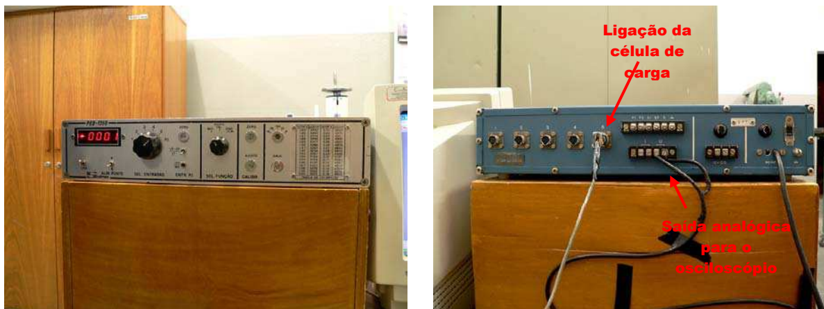
Figura 5.16 – Ponte de Wheatstone da Sodmex e o esquema de ligação da célula de carga.
