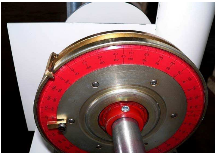
Figura 5.12 - Detalhe do goniômetro acoplado ao torquímetro.
