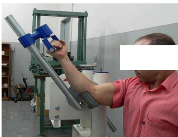
Figura 6.4 – Voluntário posicionado e aplicando esforço máximo no torquímetro em um ângulo pré-determinado.
