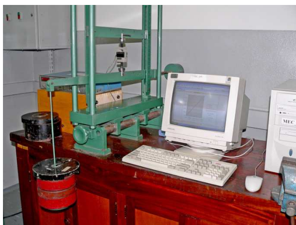
Figura 5.18 - Vista geral da montagem utilizado na calibração da célula de carga.
