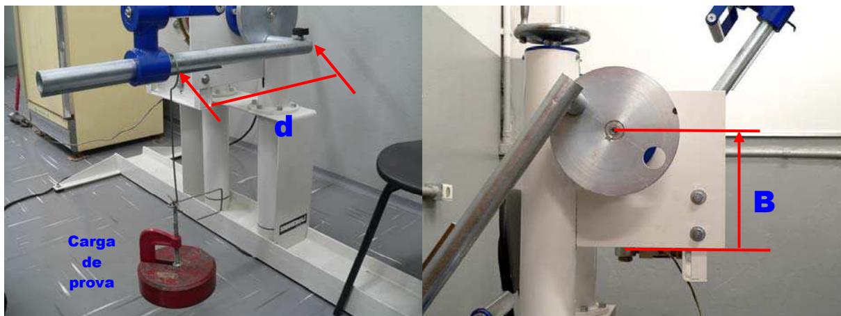
Figura 5.22 - Braço efetivo do Torquímetro, evidenciando as distâncias B e d.
