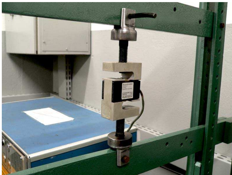
Figura 5.20 - Detalhe da fixação da célula de carga ao suporte.
