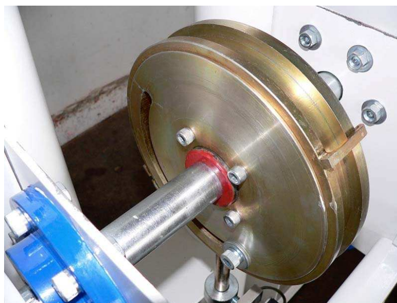
Figura 5.11 - Detalhe mostrando o parafuso e a ranhura para regulagem de posição.
