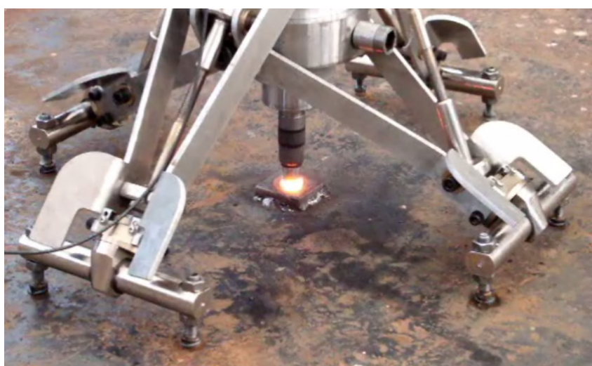
Figura 5.14: Ensaio de FHPP. Força axial de 20 kN e rotação de 5.000 rpm.
