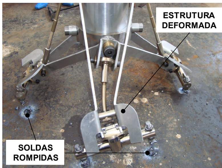
Figura 5.4: Estrutura deformada devido ao rompimento das soldas.
