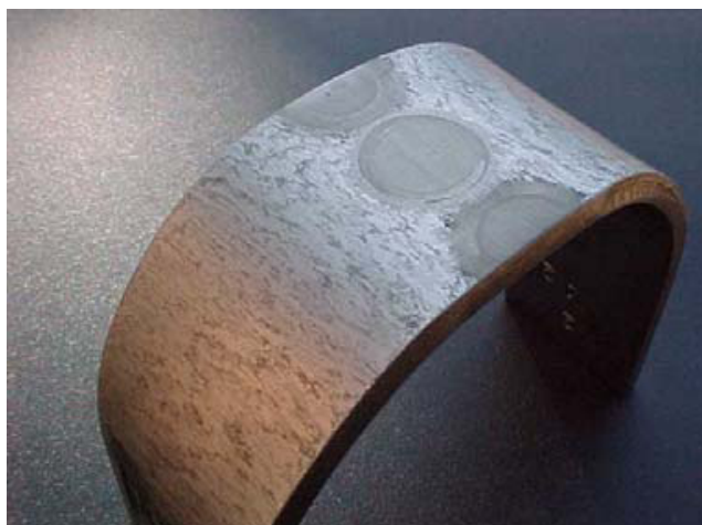
Figura 2.13: Amostra transversal de raiz com dobramento a 180° (PIRES, 2007).
