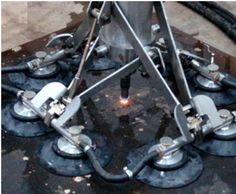
Figura 5.10: Processo de soldagem por atrito de um pino roscado.
