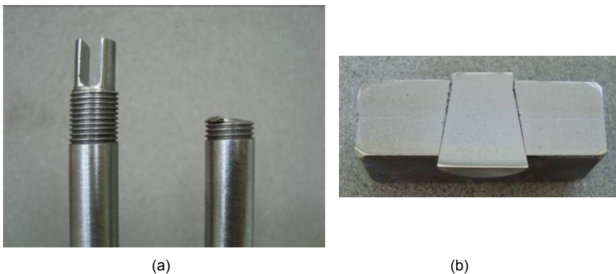
Figura 5.17: (a) pino original (esquerda) e pino rompido durante o ensaio (direita); (b) corte transversal de amostra do ensaio FPPW, 6 kN e 5.000 rpm.
