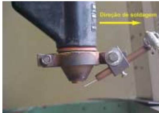
Figura 3.5- Posicionamento da alimentação de arame na solda (sentido do movimento →).
