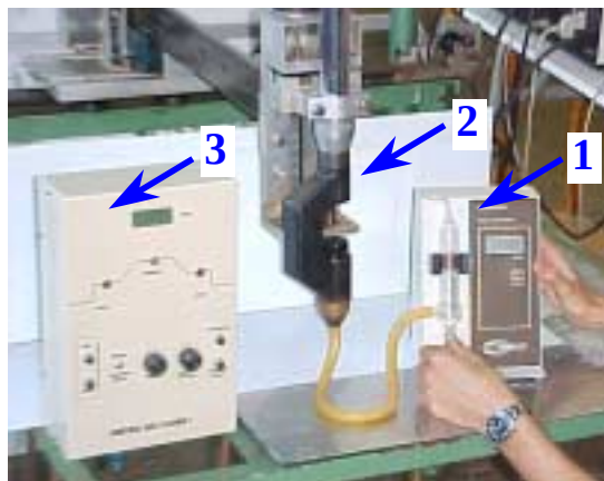
Figura 8.2- Sistema para a calibração do medidor de vazão do gás de plasma sendo: bolhímetro digital (1), tocha de soldagem (2) e medidor de vazão de gás de plasma (3).
