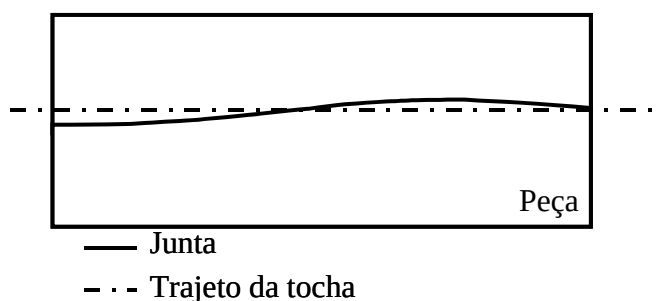
Figura 9.13- Exemplo de desvio que pode ser corrigido com a técnica do direcionamento do arco com um trajeto de fluxo.
