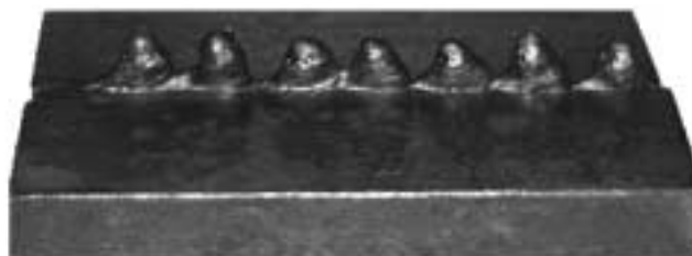
Figura 2.12- Defeito “ humping ” na raiz da solda (Richetti, 1998).
