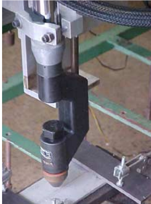
Figura 3.2- Tocha de soldagem a plasma PWM-300 da Thermal Dynamics Corporation.
