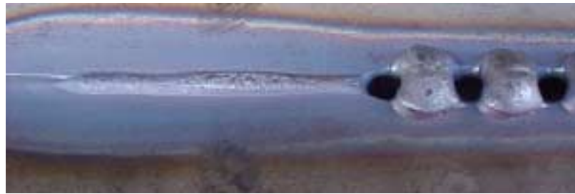
Figura 7.12- Instabilidade do “keyhole” com o hélio como gás de proteção (raiz da solda).
