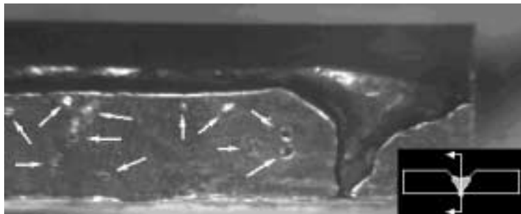
Figura 2.13- Porosidade interna na solda e cratera do “keyhole” (Richetti & Ferraresi, 2000a).
