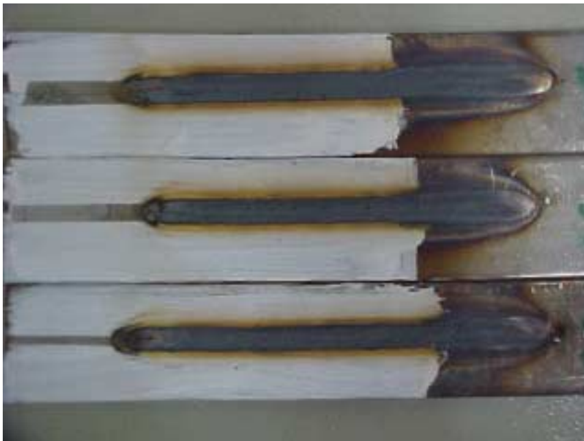
Figura 9.17- Testes realizados na soldagem com “keyhole” usando aberturas de 8, 5 e 3 mm (de cima para baixo, respectivamente) entre as camadas de fluxo (trajeto do arco).
