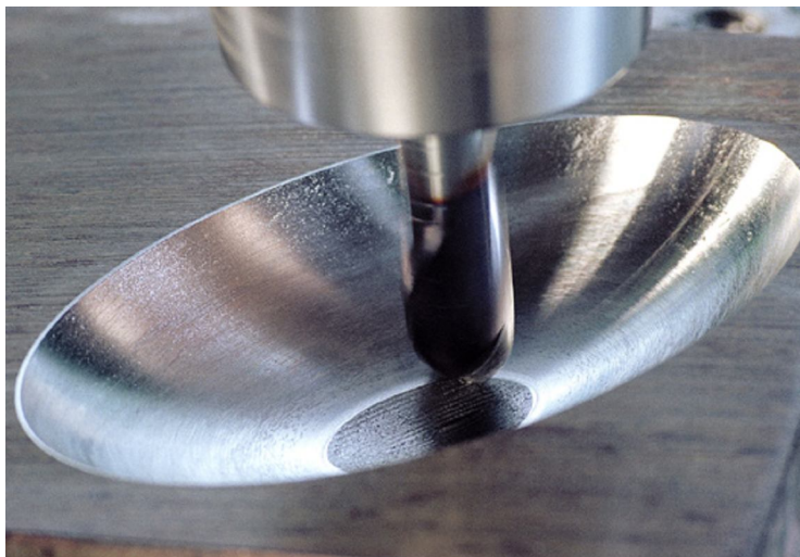
Figura 2.21 – Usinagem de cavidade em um molde (SANDVIK, 2010).
