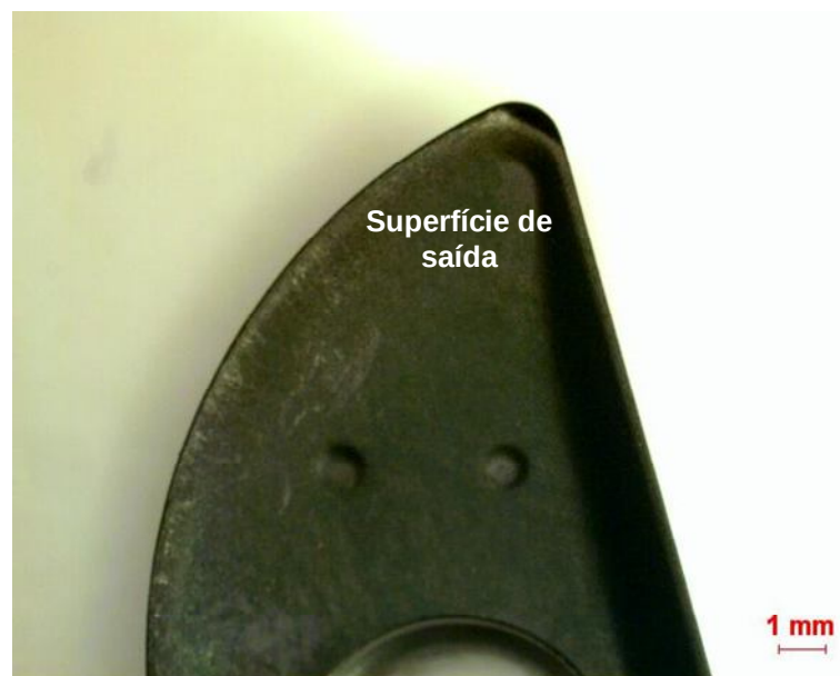
Figura 4.9 – Imagem da superfície de saída do inserto 2 (interpolação linear com tolerância igual a 0,1 mm).
