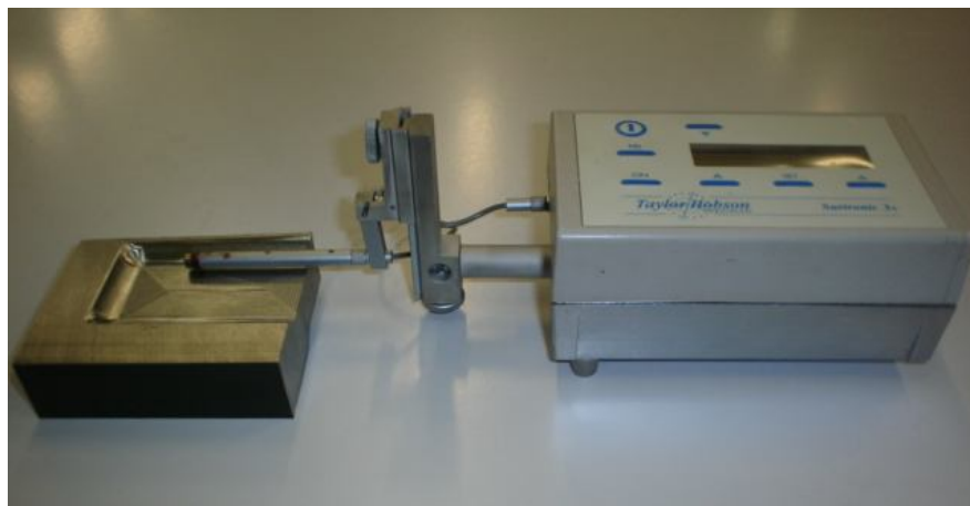
Figura 3.10 – Montagem do rugosímetro portátil surtronic 3+ para medição das peças usinadas.
