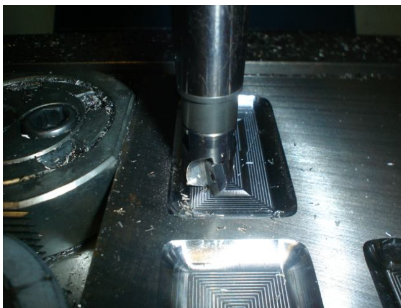
Figura 3.8 – Ferramenta em operação de fresamento de topo da cavidade usinada, para a qual foram elaborados o modelo e programa com auxílio do programa CAD/CAM.
