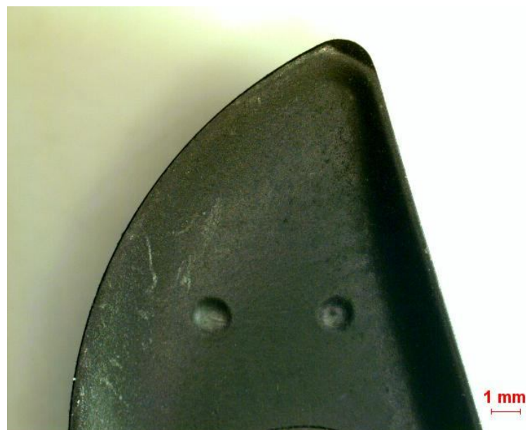
Figura 4.11 – Imagem da superfície de saída do inserto 2 após usinagem na condição linear com tolerância igual a 0,05 mm.
