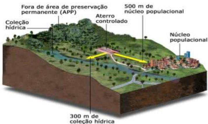
Figura 2: Esquema de um aterro controlado, com destaque para as medidas mínimas de redução dos impactos ambientais.
