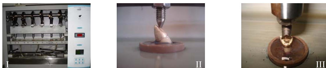
Figura 14. Ensaio de ciclagem mecânica. I) máquina de simulação de ciclos mecânicos; II) espécime posicionado em 45° em relação ao plano do solo; III) aplicação da carga no dispositivo na face palatina.
