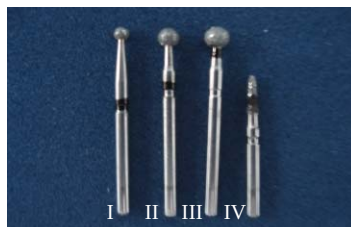
Figura 2. Pontas diamantadas usadas no desgaste para simulação do enfraquecimento radicular. I) 1016 HL; II) 3017 HL; III) 3018HL; IV) 1112.
