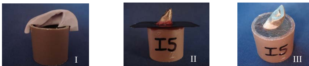
Figura 12. Inclusão dos espécimes para o ensaio de ciclagem mecânica. I) dispositivo de silicone; II) espécime posicionado em 45°; III) espécime .
