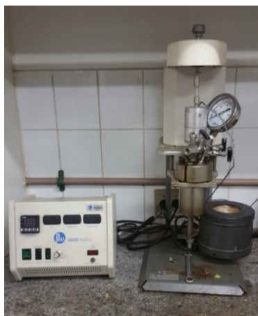
Figura 8: Reator utilizado na reação de oxipropilação.
