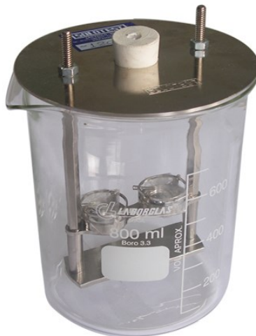
Figura 9: Representação do aparelho para ponto de amolecimento, método do anel e bola.
