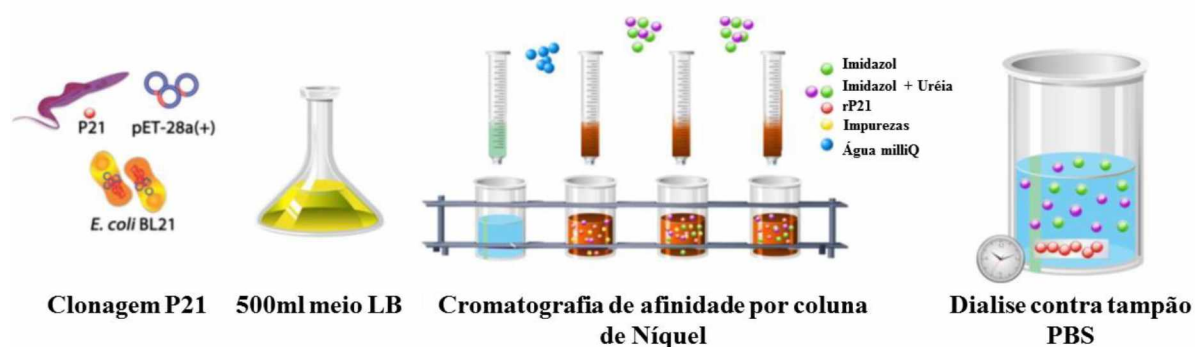
Figura 1 - Esquema do protocolo de purificação e renovelamento da rP21. Obtenção da proteína a partir dos corpos de inclusão do extrato bacteriano de E. coli utilizando meio LB, cromatografia de afinidade por coluna de níquel e diálise contra tampão PBS (Santos, 2013).
