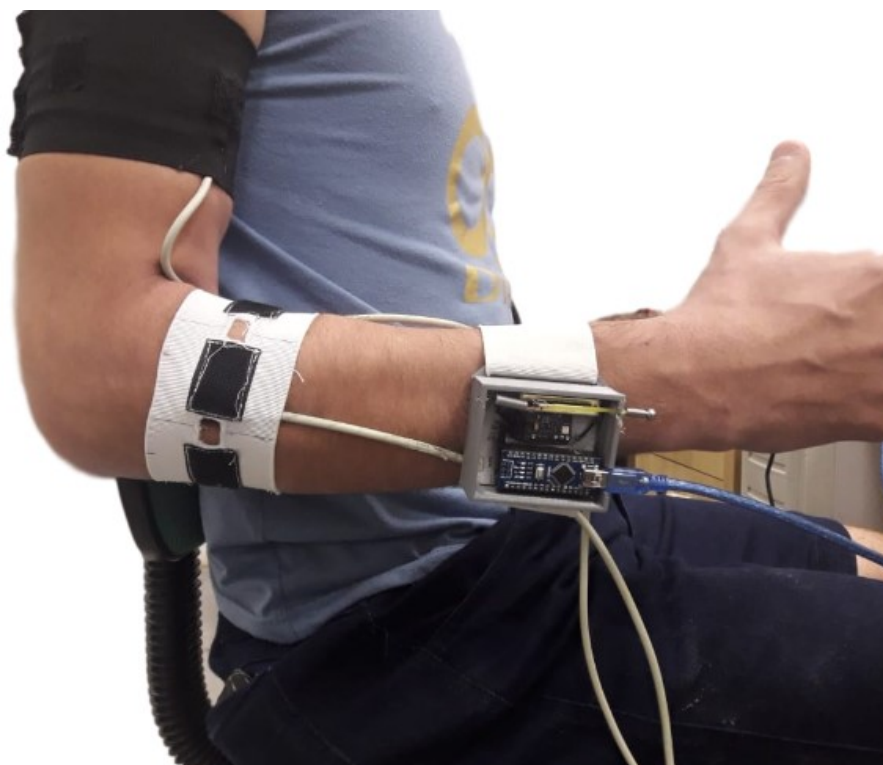
Figura 24: Esquema de montagem para o controle utilizando sinais EMG.
