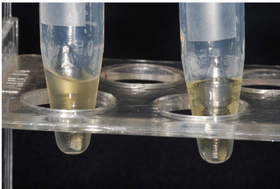
Figura 17 – Resultado positivo para microinfiltração T20 (esquerda). Amostra com resultado negativo (direita)
