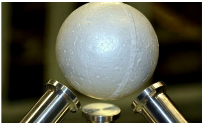
Figura 2.8: Exemplo de aparato de levitação acústica. Fonte: [15]
