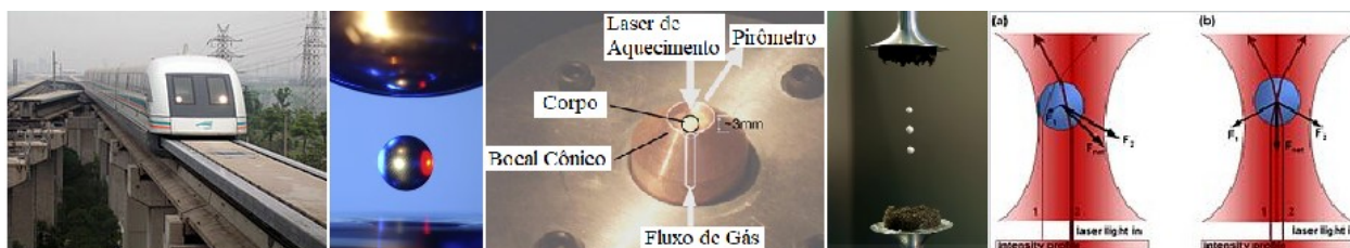
Figura 1.4: Tipos diferentes de levitação. Da esquerda para a direita: Magnética, Eletrostática, Aerodinâmica, Acústica e Óptica. Fonte: [20]
