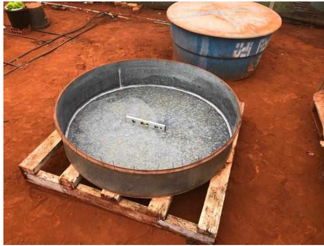
Imagem 3. Tanque Classe A, nivelado sob um estrado de madeira
