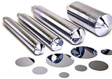
Figura 3.1 - Exemplos de Lingotes de Silício monocristalino e wafers.
