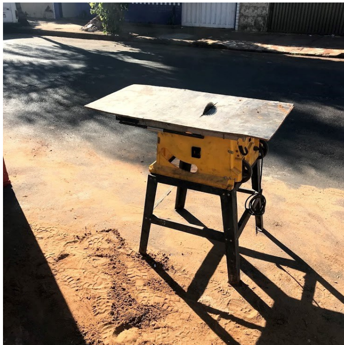
Figura 6 Serra circular devidamente equipada e disposta
