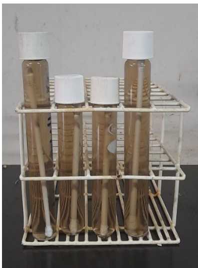
Figura 14. Imersão da fibra oca cerâmica de alumina em solução de dopamina. Fonte: O autor
