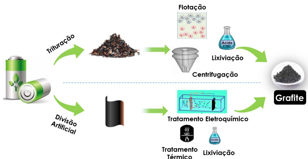
Figura 2. Abordagens de reciclagem de grafitas de LIBs. Fonte: Liu et al. (2022)
