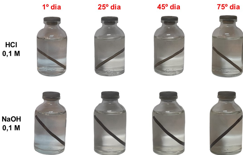
Figura 48. Teste de estabilidade a longo prazo da membrana (OG/EDA-4)D4 em soluções ácidas e alcalinas. Fonte: O autor.
