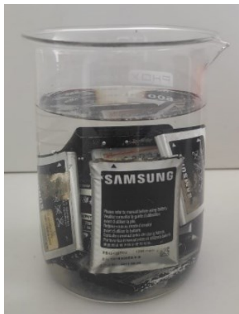
Figura 10. Baterias mergulhadas em solução salina. Fonte: O autor
