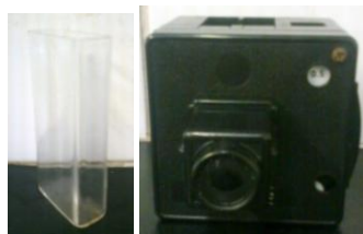
Figura 17: Colorímetro Orbeco-Hellige para determinação de Cor ASTM.
