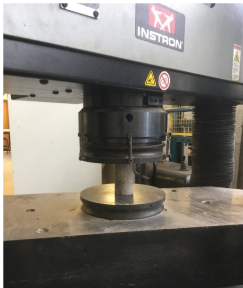
Figura 9 – Ensaio de resistência à compressão axial
