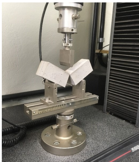
Figura 14 – Corpo de prova no momento da ruptura na máquina
