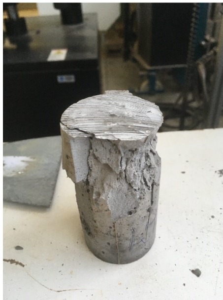
Figura 12 – Amostra após o ensaio de resistência à compressão com mistura de proporção 1:0,176
