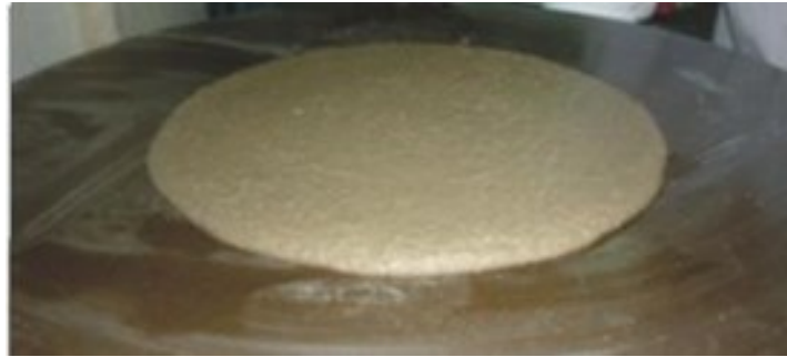
Figura 3 – Mistura após as 30 quedas preconizadas pela ABNT NBR 13276:2002
