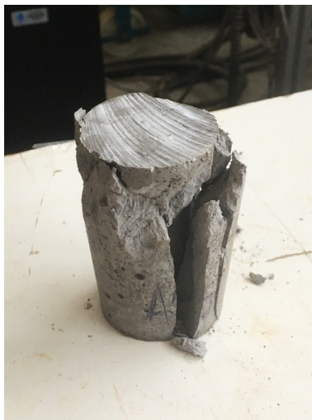
Figura 13 – Amostra após o ensaio de resistência à compressão com mistura de proporção 1:0,333
