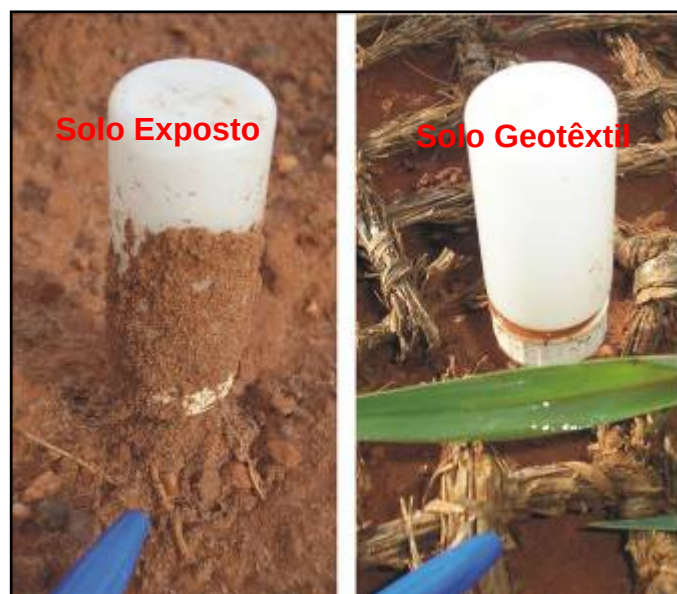
Fig. 59 – Diferença no splash erosion nas parcelas solo exposto e solo com geotêxteis. Autoria: BEZERRA, J.F.R, 25.11.05.
