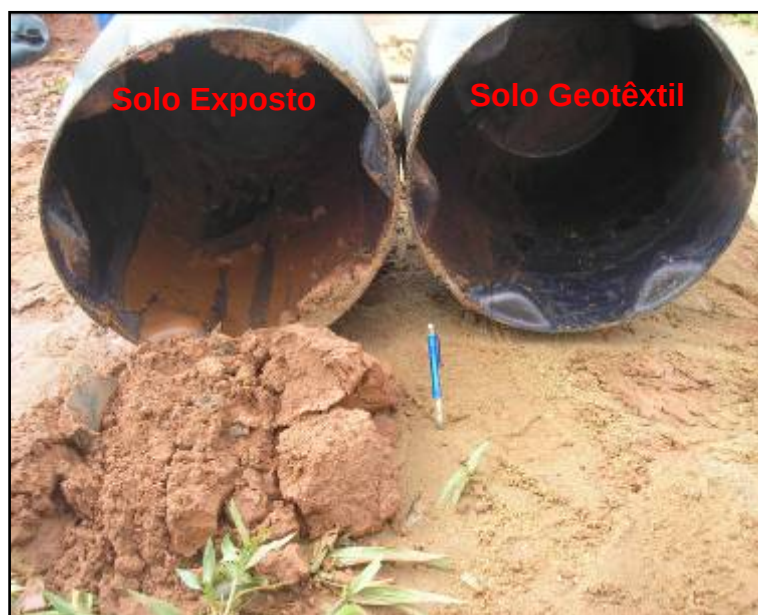
Fig. 64 – Diferença na produção de sedimentos nas parcelas com solo exposto e solo com geotêxteis sem a vegetação.
