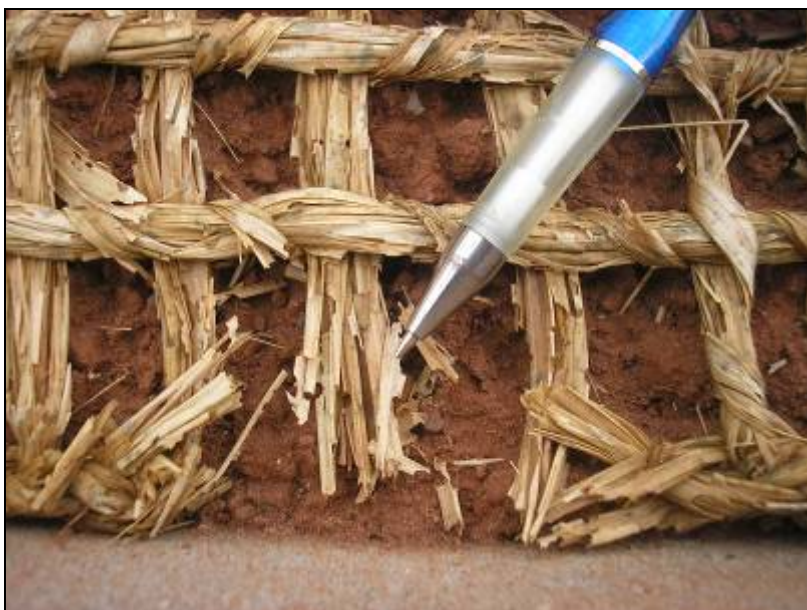
Fig. 18 – Vista parcial do processo de biodegradação do geotêxtil fornecendo matéria orgânica para o solo no início do monitoramento.
