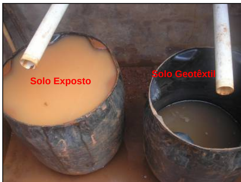
Fig. 44 – Diferença na geração do escoamento nas parcelas solo exposto e solo com geotêxteis e gramíneas.
