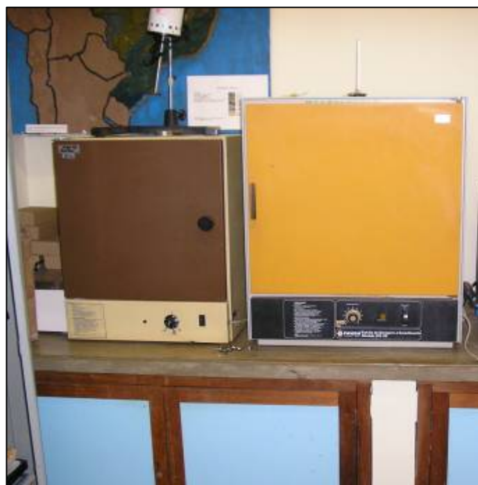
Fig. 10 – Estufas utilizadas para secagem das amostras. Autoria: BEZERRA, J. F. R, 15.05.05.
