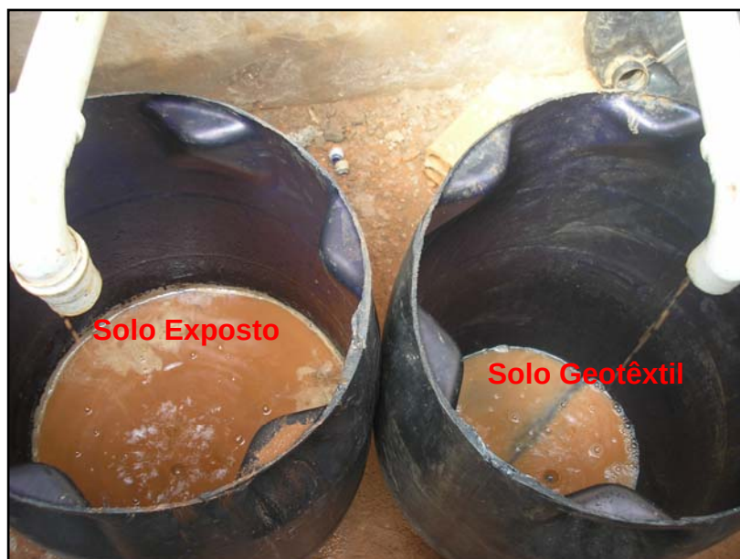
Fig. 43 – Diferença na geração do escoamento nas parcelas solo exposto e solo com geotêxteis sem a presença de vegetação.
