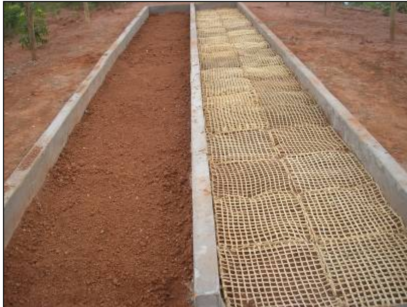
Fig. 23 – Vista da estação experimental durante a influência dos geotêxteis sobre a umidade superficial. Autoria: BEZERRA, J.F.R, 19.11.05.
