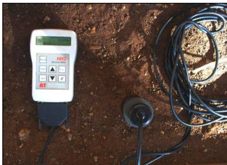
Fig. 07 - Utilização do medidor de umidade superficial.
