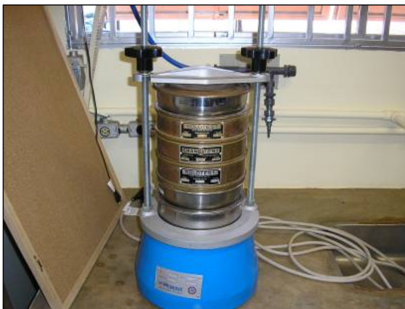
Fig. 09 – Agitador e Jogo de peneiras para a análise granulométrica. Autoria: BEZERRA, J. F. R, 15.05.05.
