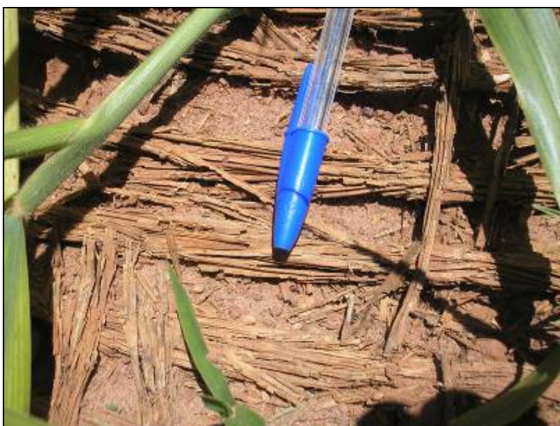
Fig. 19 – Processo de biodegradação do geotêxtil fornecendo matéria orgânica para o solo no penúltimo mês de monitoramento.
