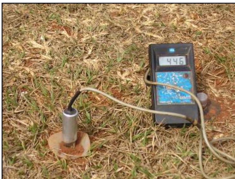
Fig. 08 - Utilização de tensímetro para a medição do potencial matricial. Autoria: BEZERRA, J. F. R, 18.07.06
