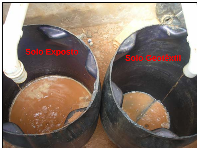
Fig. 63 – Diferença na geração do escoamento nas parcelas solo exposto e solo com geotêxteis sem a presença de vegetação.
