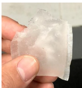
Figura 29 - TB3 com perda de material devido ao rompimento do grampo
