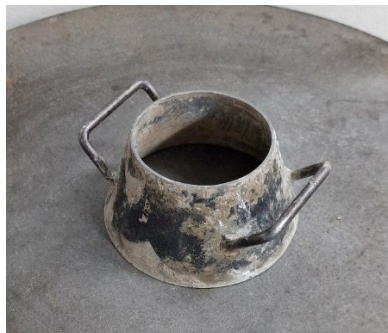
Figura 15 - Cone para medição do espalhamento de argamassa
