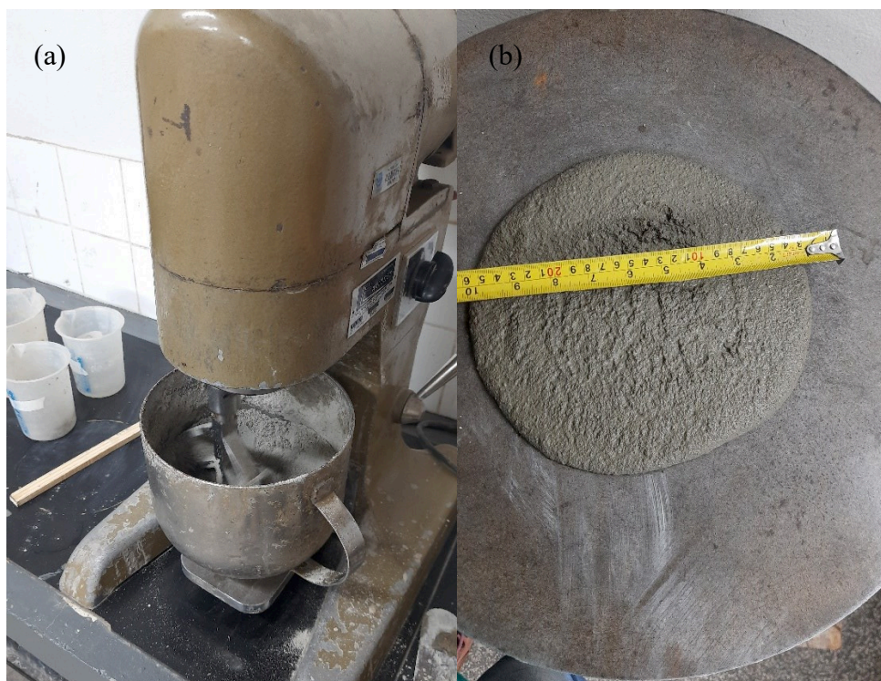
Figura 31 – Ensaio slump flow : (a) argamassadeira durante mistura, e (b) medida do espalhamento de argamassa com uma trena
