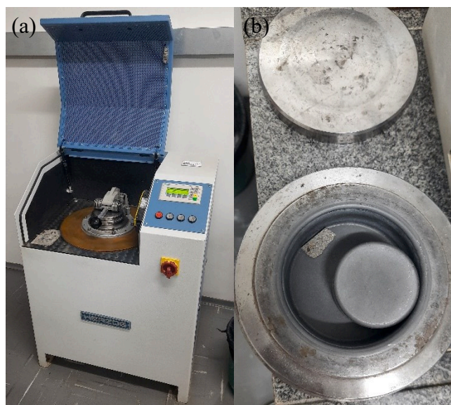
Figura 20 – Triturador mecânico utilizado para pulverizar amostras, (a) equipamento aberto, (b) panela de moagem.
