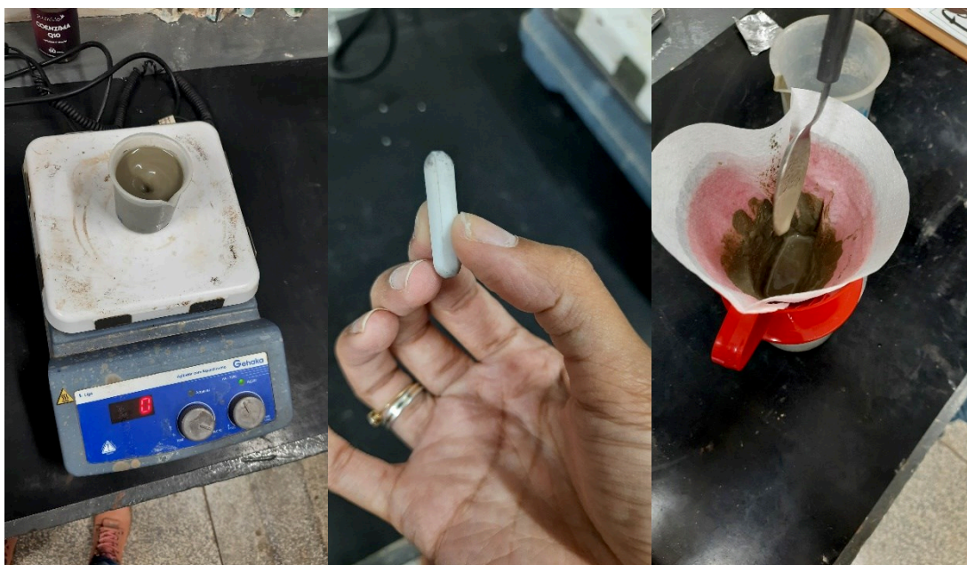
Figura 28 - Obtenção de filtrado da pasta de cimento, por mistura de 24 horas
