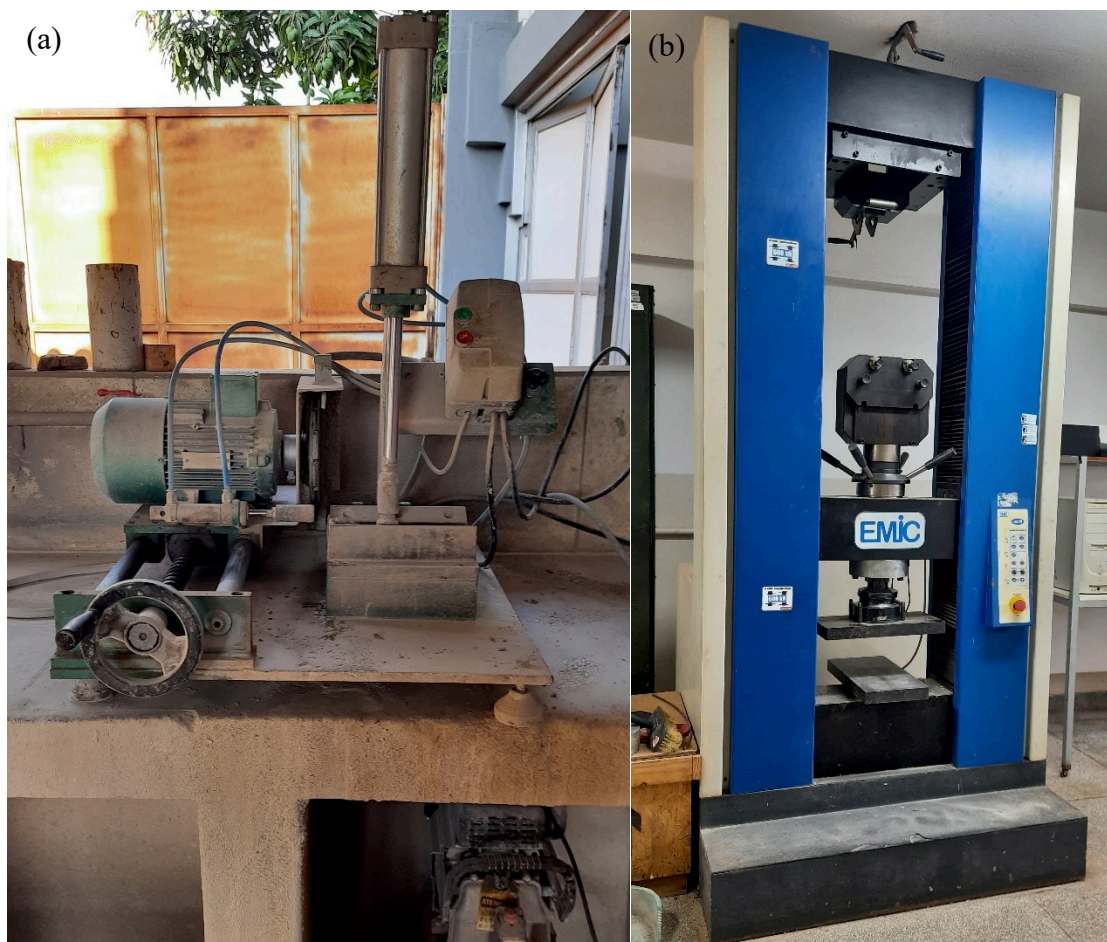
Figura 19 – (a) Equipamento utilizado para a retificação dos corpos de prova; (b) Equipamento utilizado para romper os corpos de prova no ensaio de compressão.
