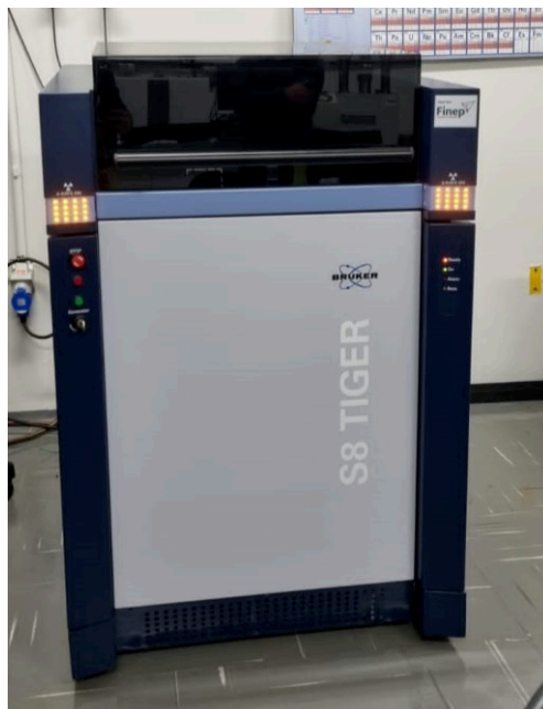
Figura 17 - Espectrômetro de FRX da marca Bruker , modelo S8 Tiger
