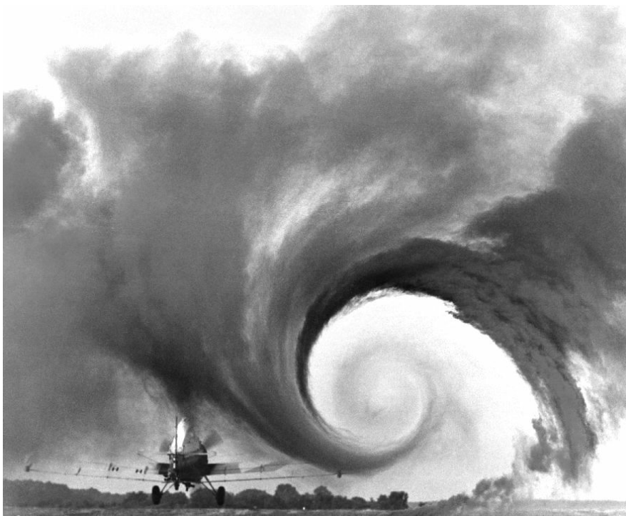
Figura 3.4 - Escoamento turbulento, esteira formada atrás de um avião (Fonte: www.nasa.gov ).
