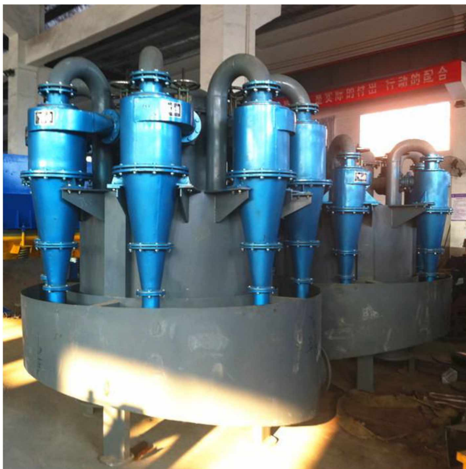
Figura 1.1 – Hidrociclone empregado na indústria mineral.
