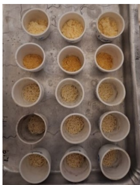
Figura 6 – Cadinhos com amostras de macarrões e ovos secos antes da análise de umidade.
