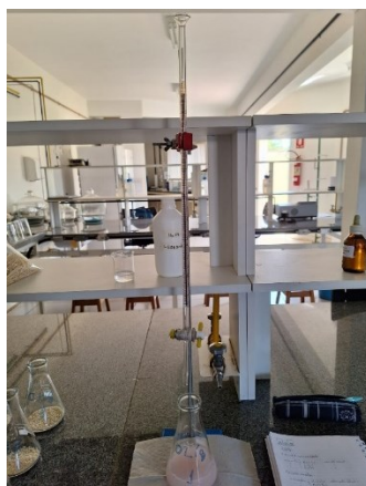
Figura 7 – Titulação para determinação de acidez.
