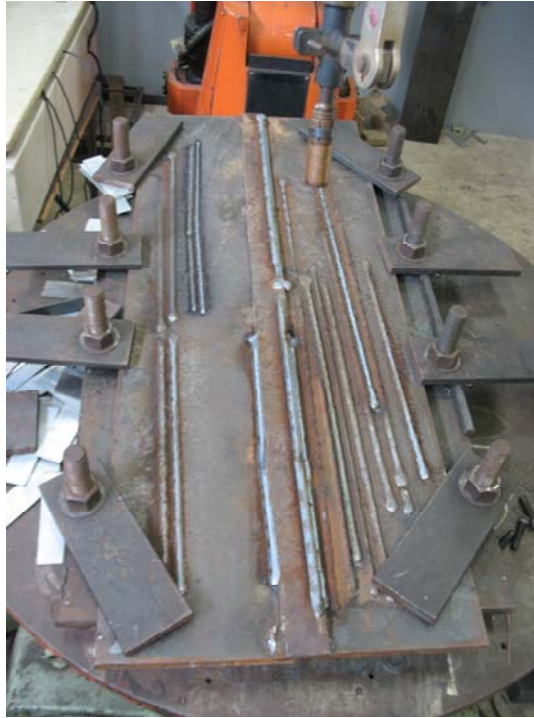
Figura 4.1 - Placa de teste para a realização dos testes preliminares fixa ao suporte para minimizar as distorções
