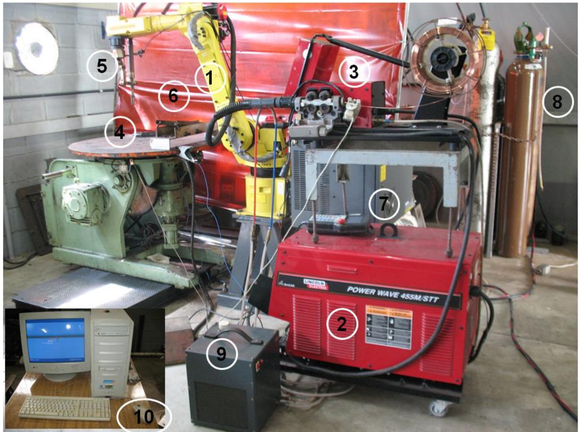
Figura 3.1 – Bancada experimental geral, onde, 1-Unidade Robótica; 2- Fonte de potência para soldagem; 3- Cabeçote alimentador; 4- Mesa; 5- Tocha; 6- Suporte para chapas de teste; 7- Controle da Unidade Robótica; 8- Cilindro dos gases de proteção; 9- Sistema de refrigeração da tocha; 10- Sistema de aquisição de sinais elétricos
