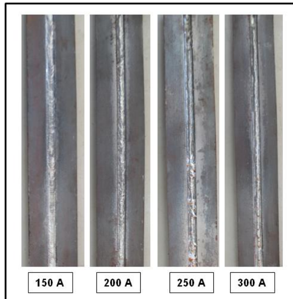
Figura 5.17- Aspectos dos cordões de solda realizados com o processo MIG/MAG com proteção gasosa de 100%CO 2 , para as correntes respectivamente de 150 A, 200 A, 250 A e 300 A.
