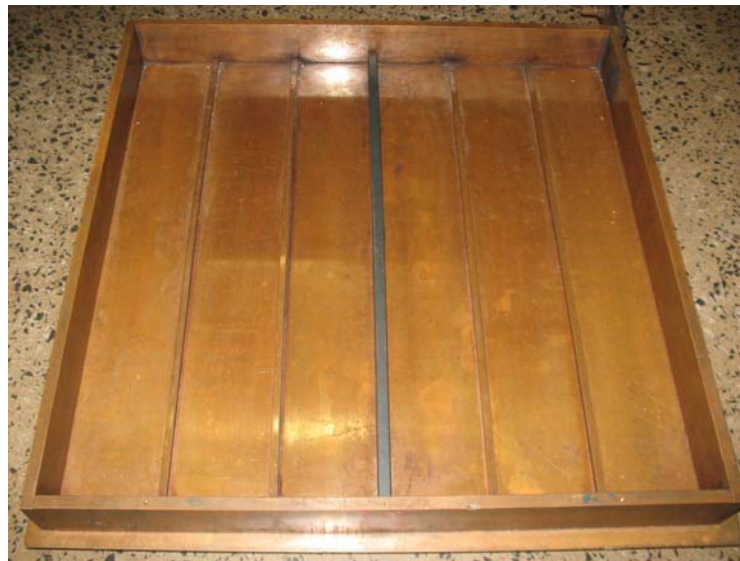
Figura 3.9- Caixa coletora de respingos com as respectivas barras que realizam as divisões para se obter os três alcances distintos
