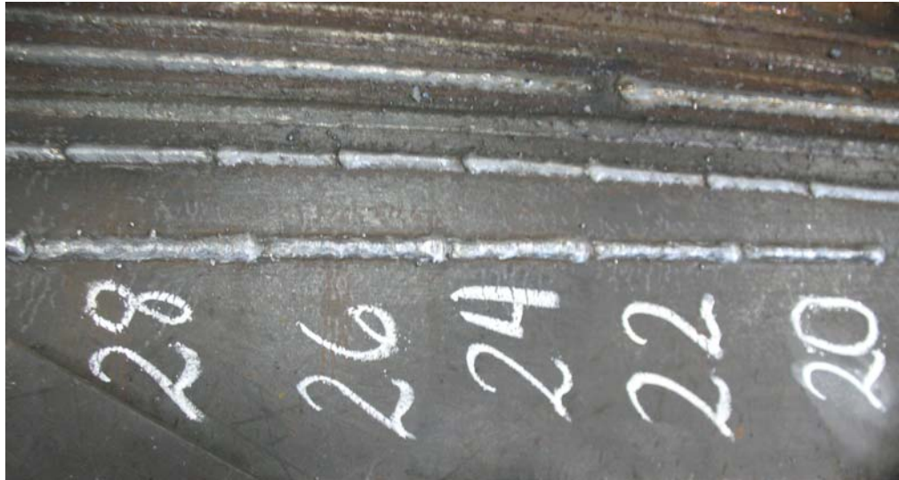
Figura 4.2- Aspectos do cordão sob diferentes valores de tensão de regulação para o arame tubular, com proteção gasosa 100% CO 2 a 200 A. Etapa de definição do cordão padrão com variação da tensão de 2 em 2 volts
