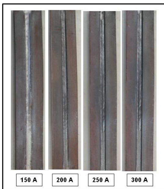
Figura 5.16- Aspectos dos cordões de solda realizados com o processo Eletrodo Tubular com a proteção gasosa de 100% CO 2 , para as correntes de 150 A, 200 A, 250 A e 300 A
