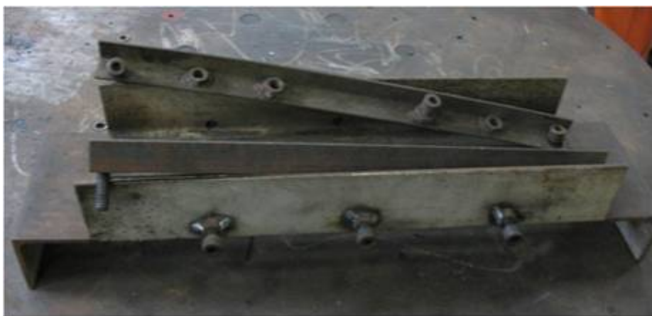
Figura 3.6- Visão geral do suporte para fixação das chapas de teste
