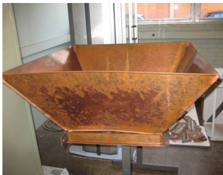
Figura 3.10- Extensor de área de coleta de respingo (“coifa”), posicionado sobre a base, deixando a mostra à região do encaixe com a base
