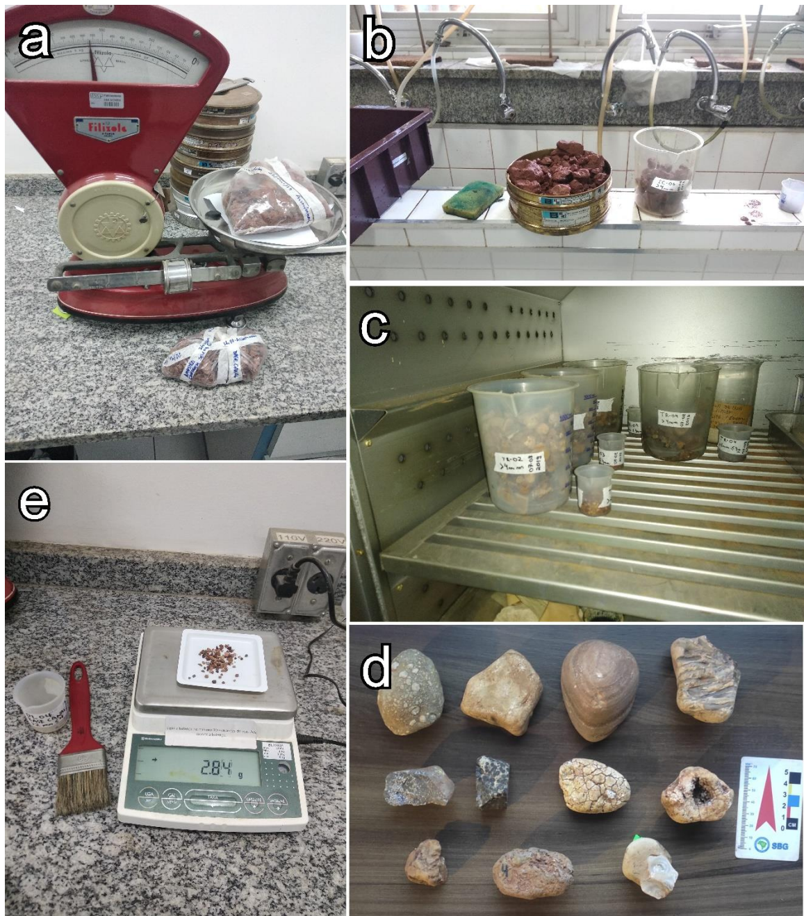
Figura 3 – Etapas das análises sedimentológicas. A) Pesagem da fração granulométrica seixo. B) Separação granulométrica e lavagem. C) Secagem em estufa. D) Litoclastos silicosos. E) Pesagem da fração grânulo.
