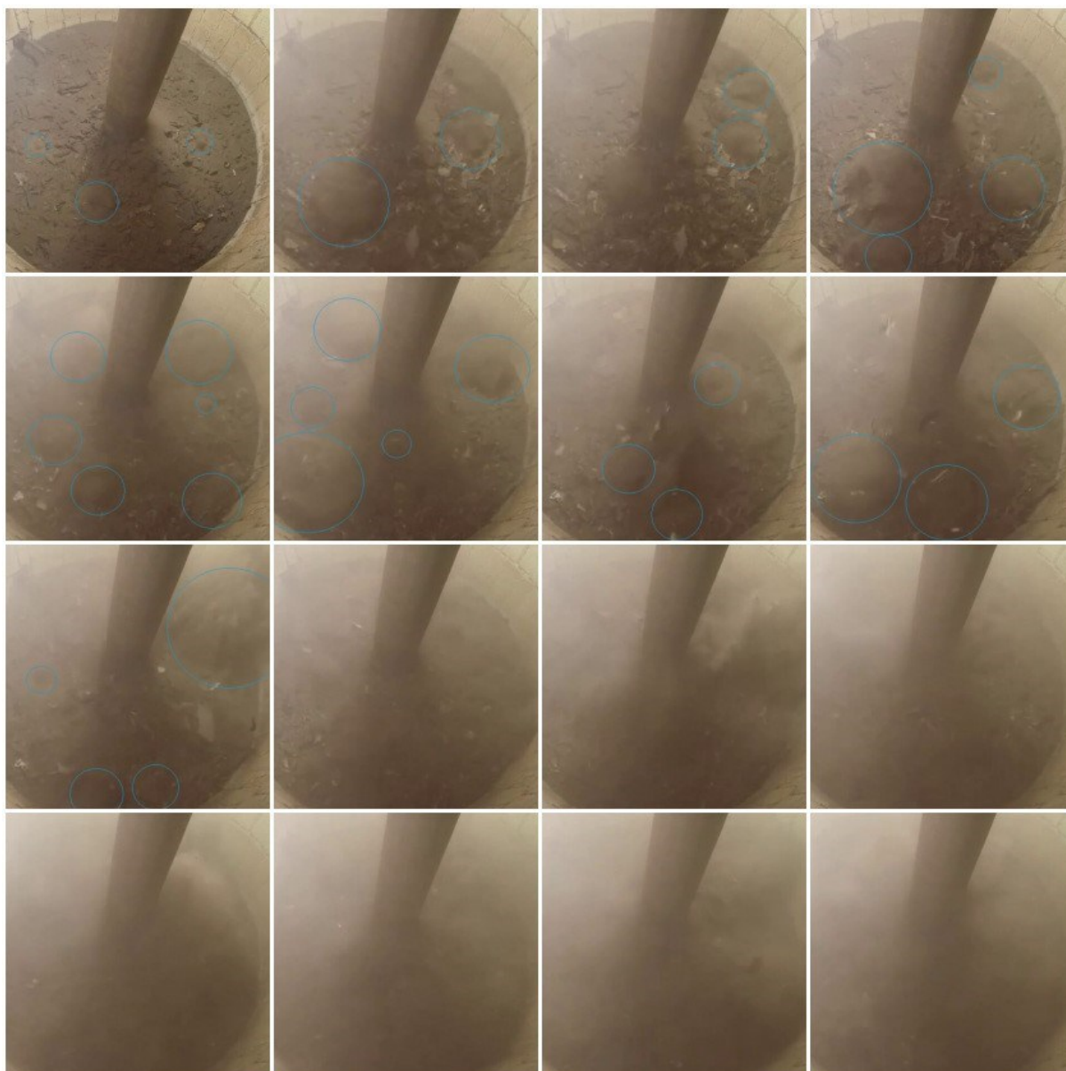
Figura 4.23 – Imagens em sequência da vídeo-captura do reator da Planta Piloto de Mauá-SP em operação. Marcações identificando bolsões de ar insuflado
