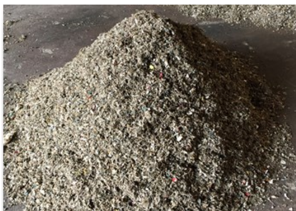
Figura 3.18 – Combustível Derivado de Resíduos Sólidos Urbanos (CDRSU) obtido por meio da tecnologia da presente linha de pesquisa (INFIESTA et al., 2019b)
