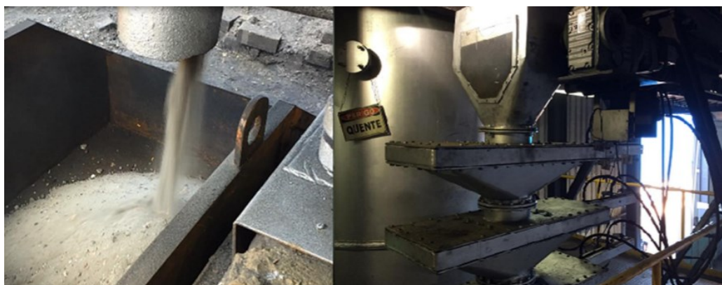
Figura 3.4 – Sistema de extração de cinzas (esquerda) e de alimentação (direita) do reator
