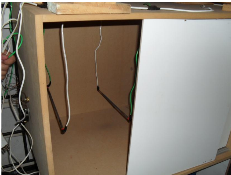
Figura 15 – Estufa confeccionada para manter a temperatura dos experimentos constante.
