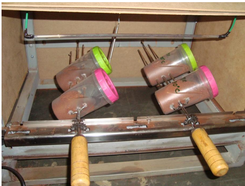
Figura 12 - Reatores do Tipo Rotativo utilizados no DCC 2.
