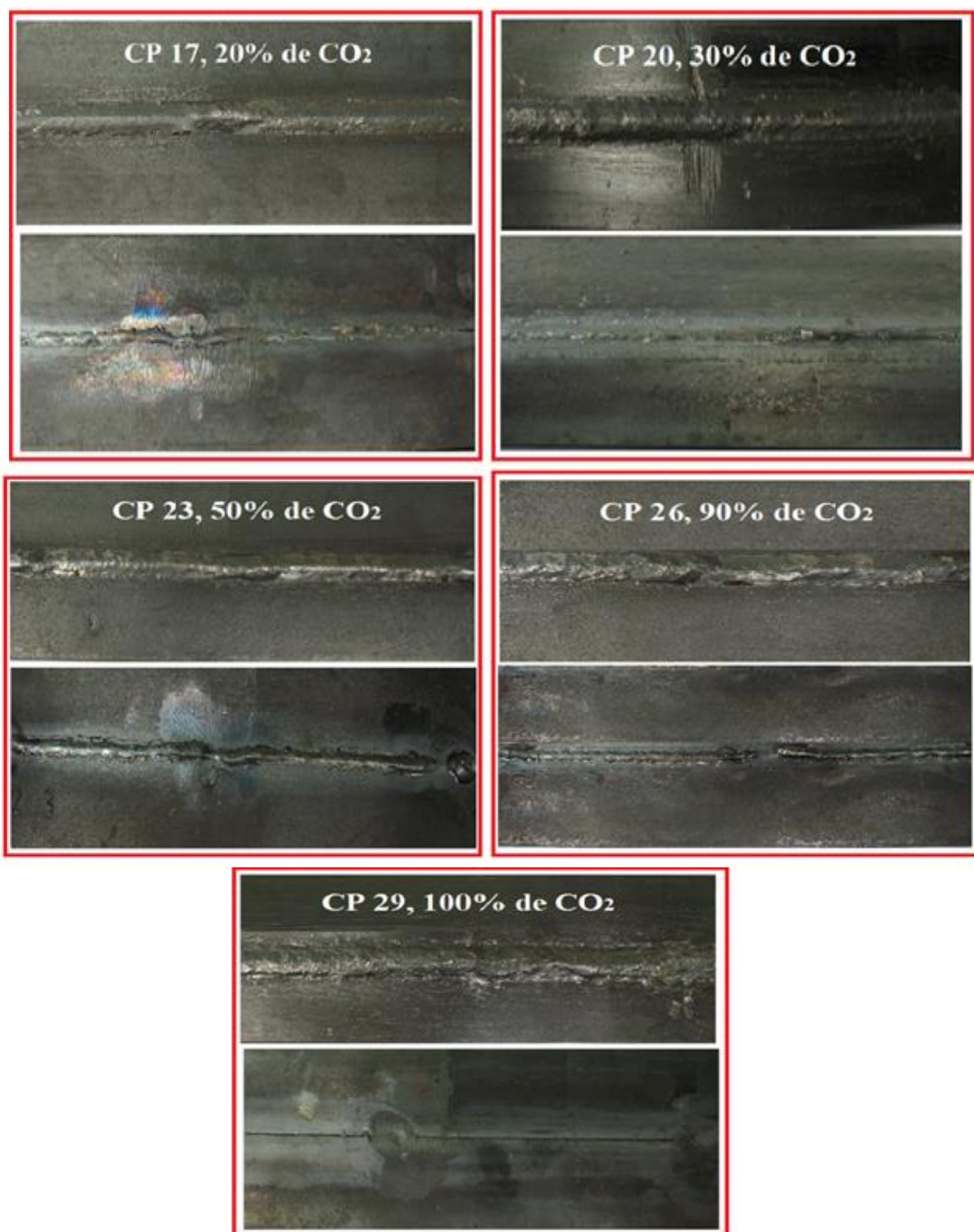
Figura 4.16 – Cordões de solda e suas raízes obtidos usando misturas com diferentes teores de CO 2
