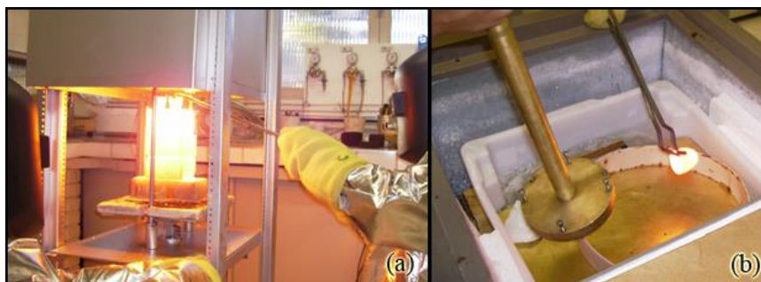
Figura 3.1. (a) Forno de alta temperatura com resistências de carbeto de silício durante o processo de retirada do cadinho e (b) melt resultante da fusão sendo entornado na placa de latão à temperatura próxima de 0°C.
