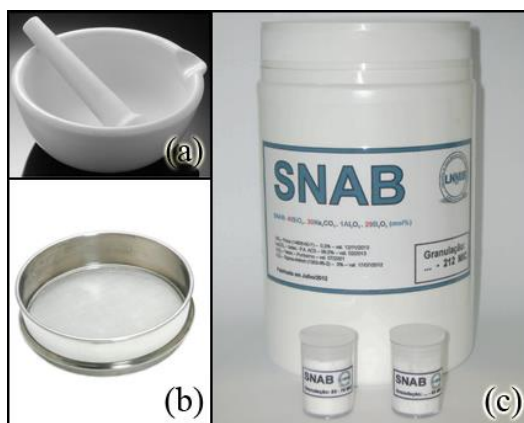
Figura 3.2. (a) Almofariz utilizado no processo de pulverização, (b) modelo da peneira granulométrica utilizada para a separação dos grãos e (c) recipientes onde foram reservadas as diferentes faixas granulométricas da Matriz Vítrea SNAB para refusão e análises em DTA e DRX.
