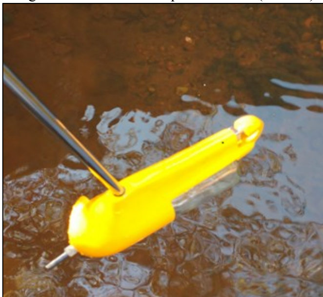
Figura 5 – Amostrador tipo USDH-48 (AMS-1)
